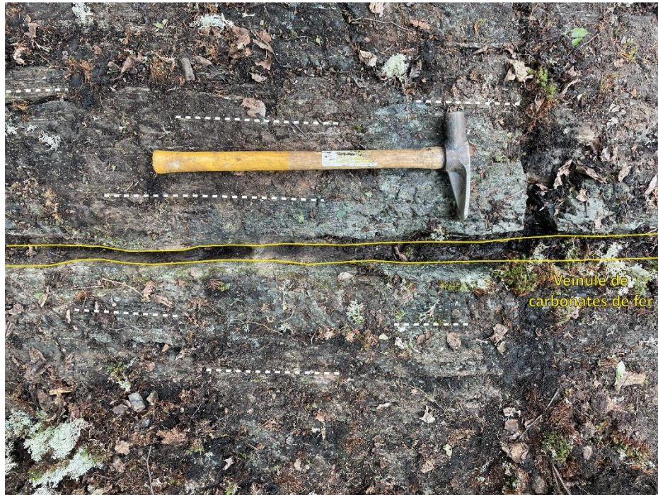
Figure 20. Photo illustrant la relation subparallèle entre les dykes/veines de carbonates de fer (en relief négatif) et la schistosité principale (tireté blanc). Affleurement 24-EF-6007.
