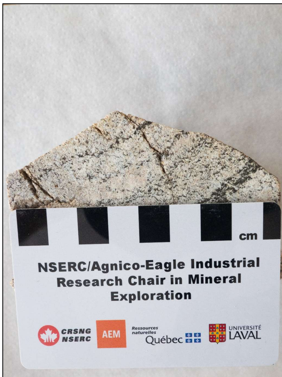
Figure 2.1 – Exemple de porosité secondaire observée dans un échantillon. Échantillon 18-MV-1016A en provenance du Grenville (été 2018)
