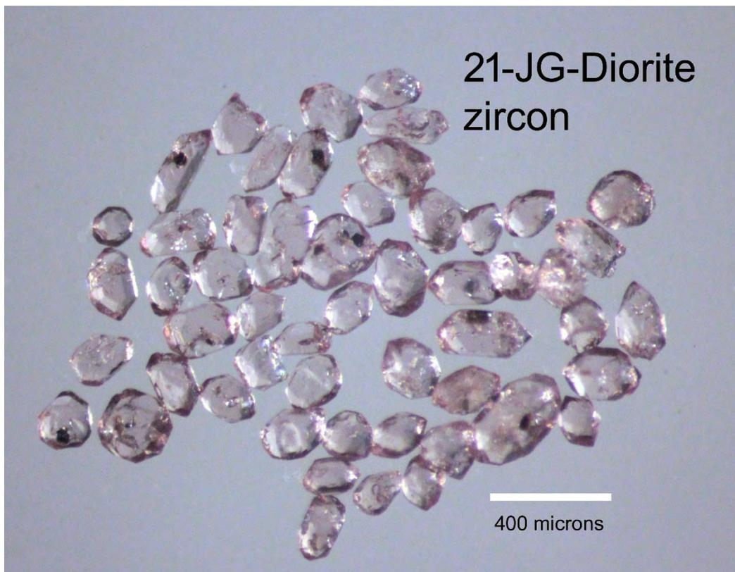
Figure 6.2.1 – Zircons sélectionnés à partir de l'échantillon 2021-JG-Diorite.
