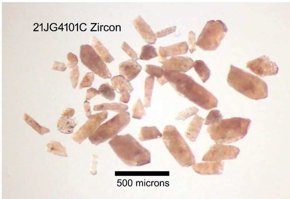
Figure 6.5.1 – Zircons sélectionnés à partir de l'échantillon de granite 2021-JG-4101C.
