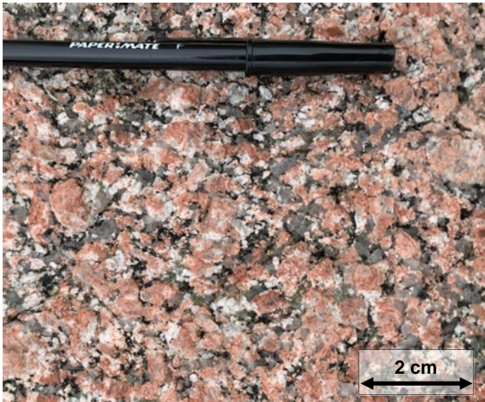
Figure 6 : Photographie de surface du granite à feldspath alcalin, affleurement 21-CS-01. Les minéraux visibles sont de la microcline (rose), du quartz (gris translucide), de l'albite (blanc) et de la biotite (noir).
