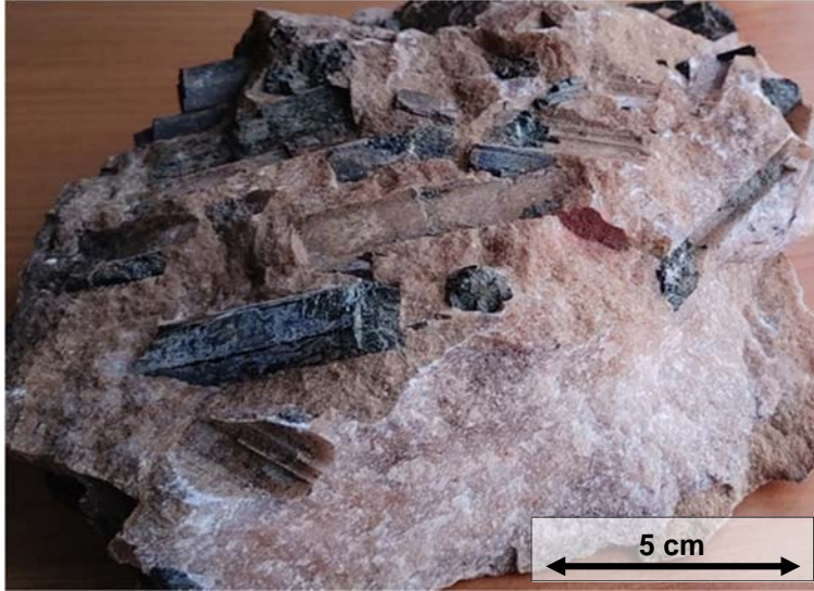
Figure 34 : Photographie d'un échantillon d'un bloc de la carbonatite du Lac des Coudes (affleurement 21-CS-04) avec des baguettes d'aegyrine de plus de 1cm de large et près de 5 cm de long.
