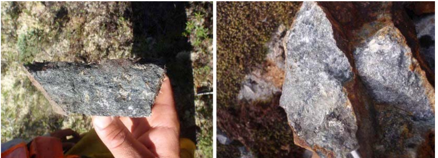
Figure 27: Échantillon de métagabbroïte contenant des sulfures disséminés à environ 10%.
