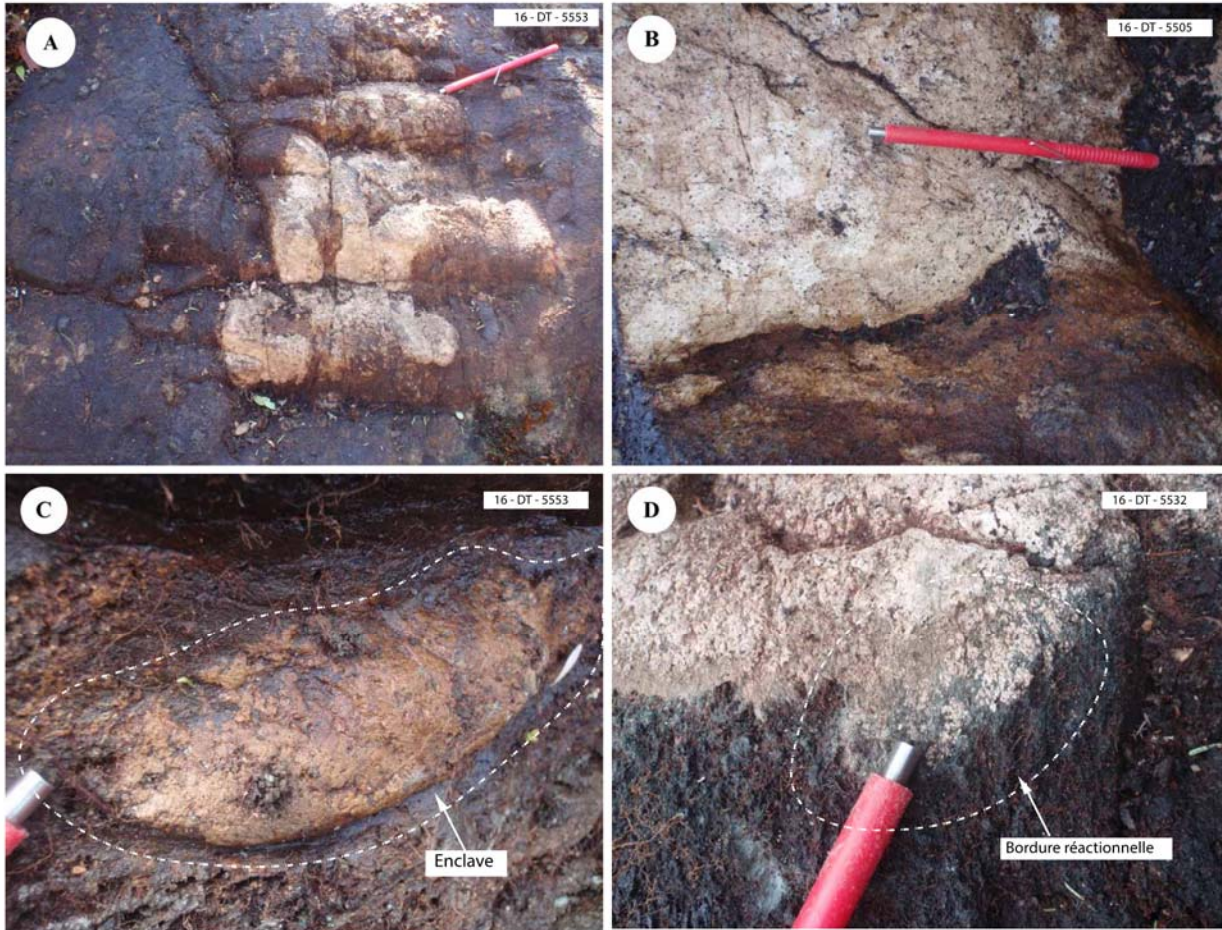
Figure 24: A. le matériel felsique qui vient recouper la roche métagabbro-noritique. B et C) les photos montrent que la roche felsique est contenue dans la métagabbro-noritique sous la forme d'enclave. D) la photo permet de voir une bordure réactionnelle entre les deux lithologies.
