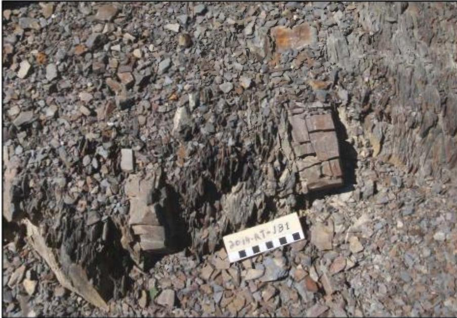
**PHOTO 1** - Interstratification de siltstone gris acier à clivage ardoisier et de wacke lithique; affleurement 14-RT-181.
