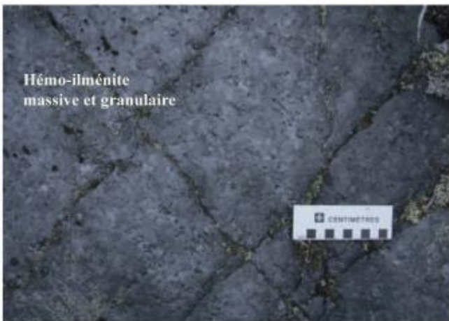
PHOTO 5 - Oxydes massifs de Fe-Ti (hémoilménite). Massif anorthositique alcalin de Labrieville. Gîte du lac Brûlé (photo Moukhsil).
