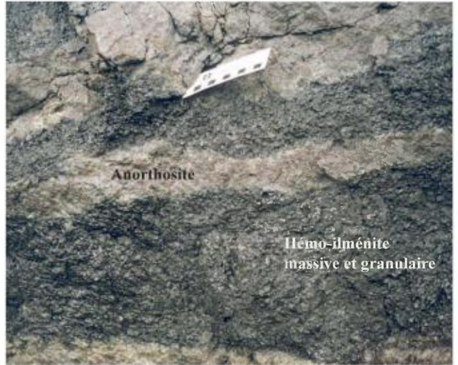
PHOTO 4 - Litage magmatique d'hémo-ilménite massive et granulaire. Mine du Lac Tio (photo A. Moukhsil).
