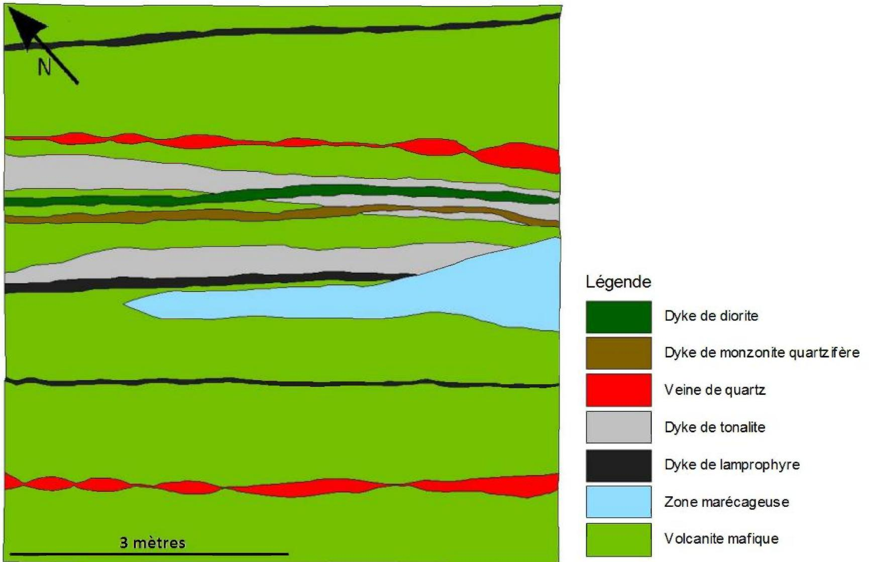
Figure 13 - Cartographie de détail d'un secteur de l'affleurement Ouest. Le cadre d'observation fait 6 m de largeur par 6 de hauteur.
