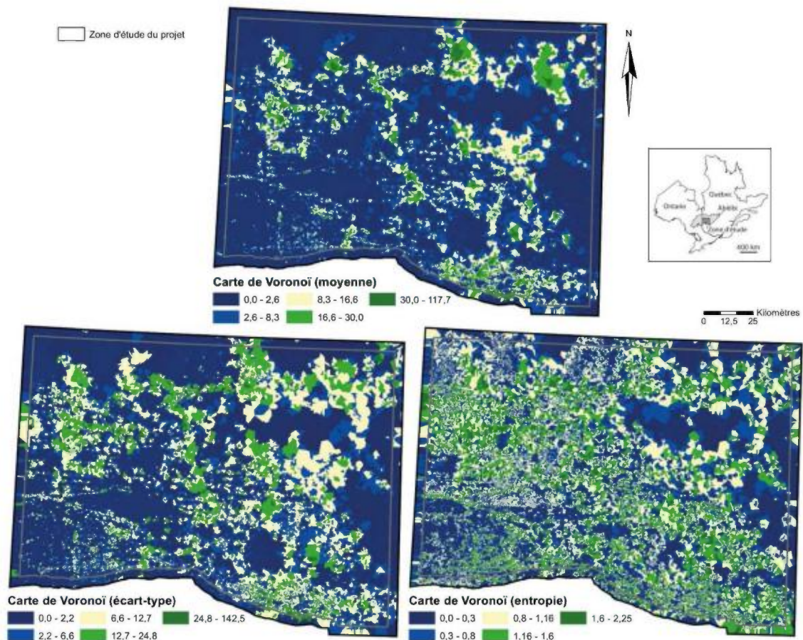
Figure 14 - Cartes de Voronoï des moyennes, des écarts-types et des entropies des données de profondeur au socle rocheux.
