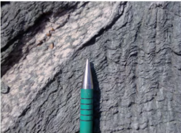
PHOTO 1.3 - Vue en détail d'un dyke variolaire synvolcanique affecté par les fabriques S1 et S2, cette dernière étant de type pression-dissolution (subparallèle au crayon).
