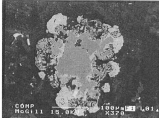
B : Image en électrons rétrodiffusés (IER) d'un grain de rutile chromière (gris foncé) en voie de remplacement par l'ilménite manganésifère du type 2.
