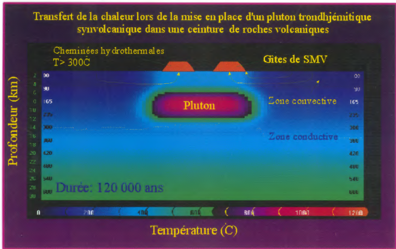
Figure 26. Calcul numérique et présentation graphique des perturbations thermiques associées à la mise en place d'une tonalite synvolcanique à faible profondeur dans la croûte archéenne. Ce modèle, calculé à partir de données réalistes pour une ceinture verte archéenne, montre qu'il est possible de réchauffer la partie supérieure de la croûte et de former des cellules hydrothermales de haute température pouvant générer des gîtes de SMV.
