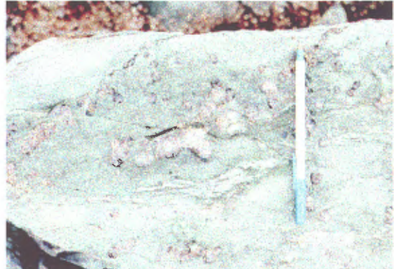
D : (98033) Basalte coussiné altéré du faciès 2, caractérisé par la présence de cristaux idiomorphes de grenat dans une matrice verdâtre riche en chlorite, en actinote et en biotite.
