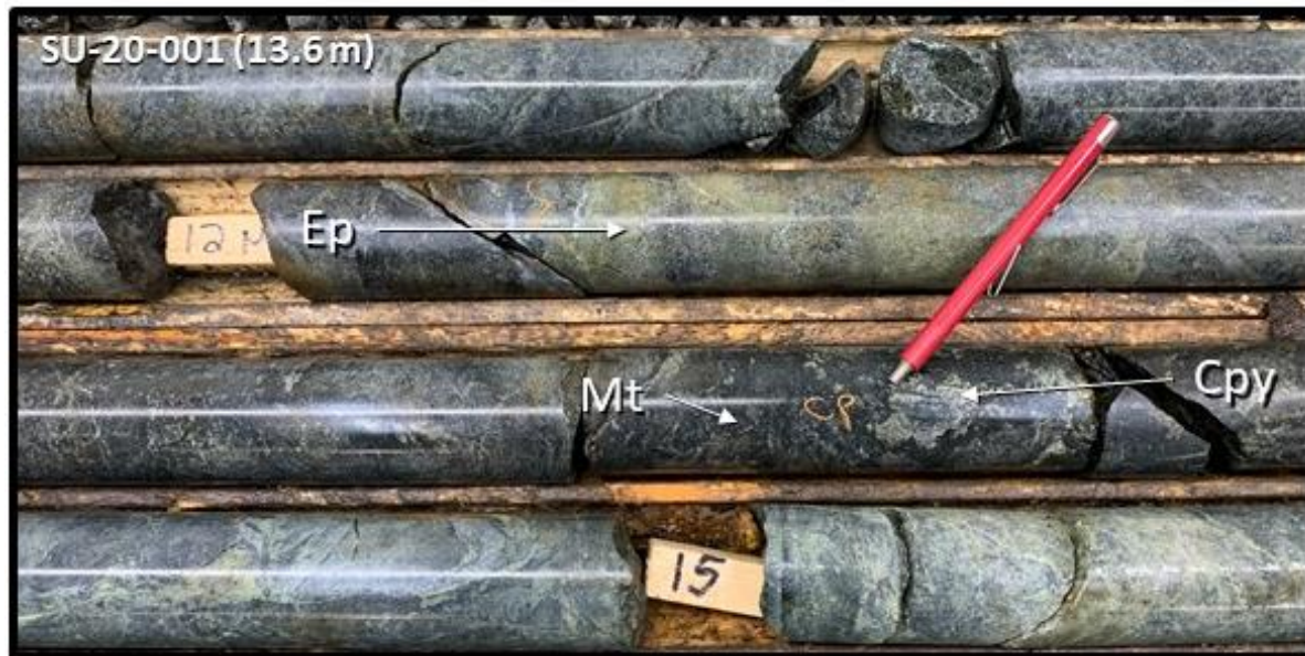
Figure 12. Photographie de carotte de forage du début du sondage SU-20-001 montrant l'altération en épidote et magnétite. De la chalcoppyrite est associée avec la magnétite.
