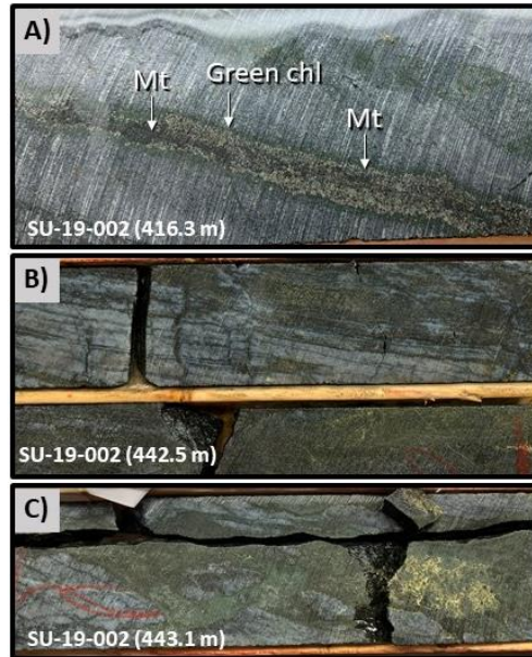
Figure 10. Photographies de carottes de forage (dimension NQ) de la zone minéralisée dans le sondage SU-19-002. A) Veinule de magnétite entourée de pyrite et sphalérite et avec un halo de chlorite verte dans une zone fortement silicifiée; B) veinules de chalcopryrite-pyrite et un peu de sphalérite et magnétite qui sont dans une zone fortement silicifiée; C) Bande/veine de chlorite verte avec chalcopryrite-pyrite et un peu de magnétite dans une zone fortement silicifiée.
