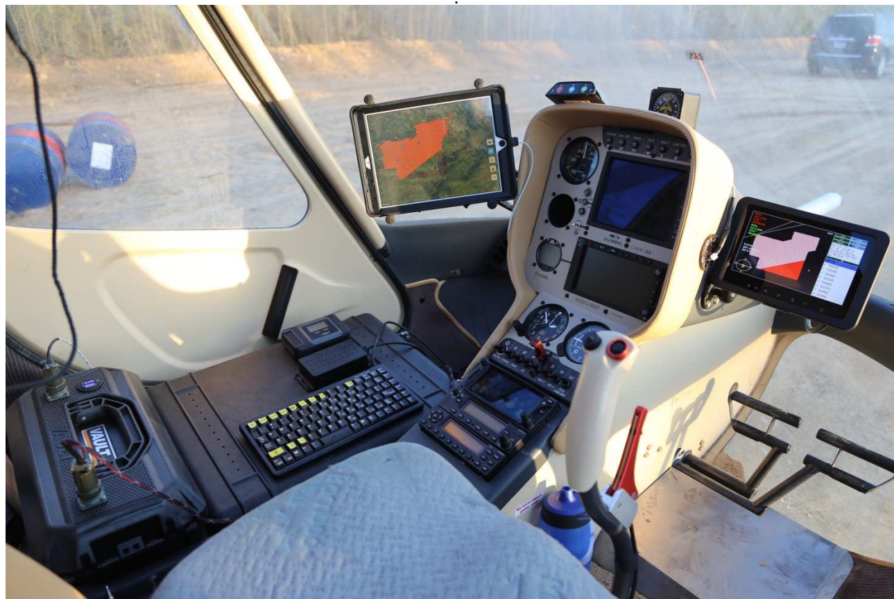
Figure 6 : Système d'acquisition et de navigation (SAMM) installé dans l'hélicoptère
