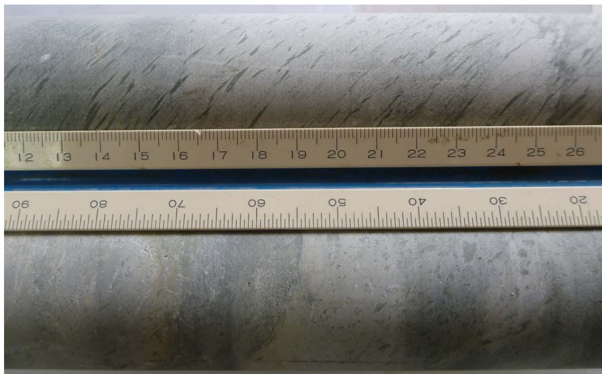
Photo 4 : Tuf à bloc non déformé en bas et moyennement déformé en haut. Les amas de chlorite sont présents dans la matrice et les fragments
