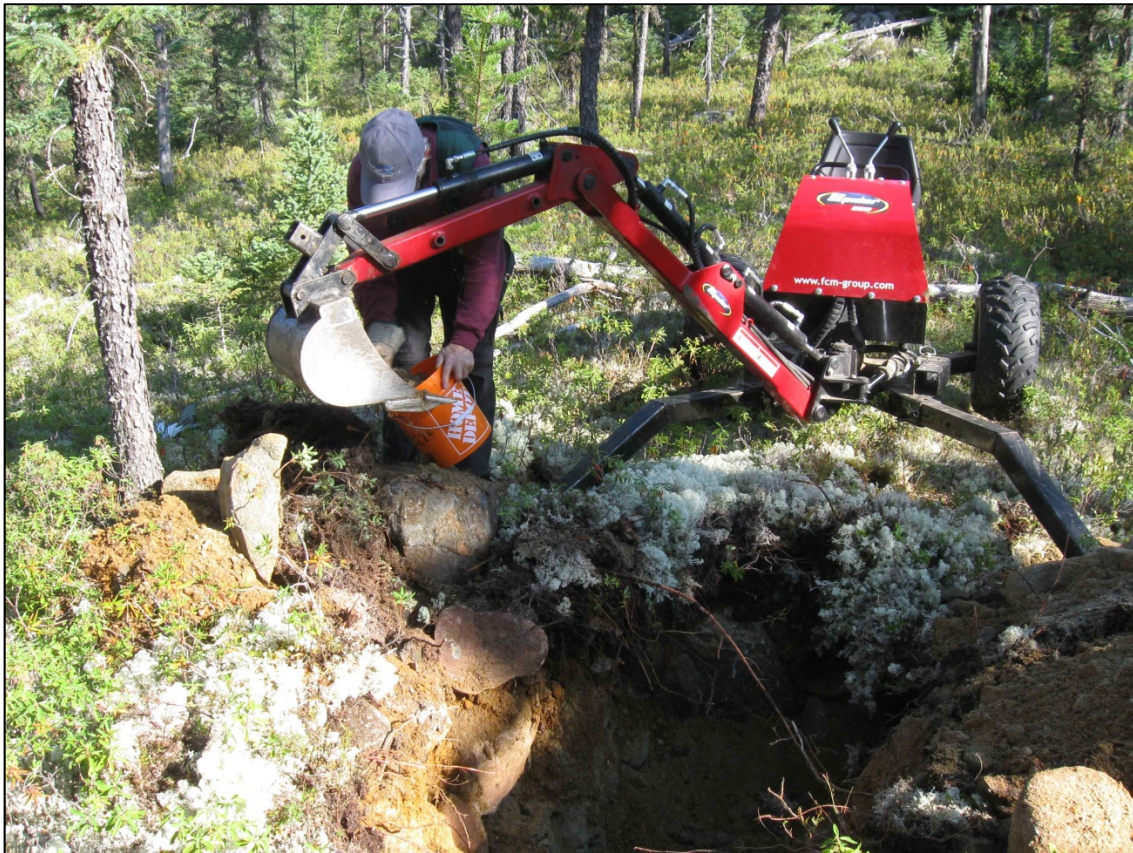
Figure 4 : Échantillonnage de till à l'aide d'une mini-pelle hydraulique Spider 800.
