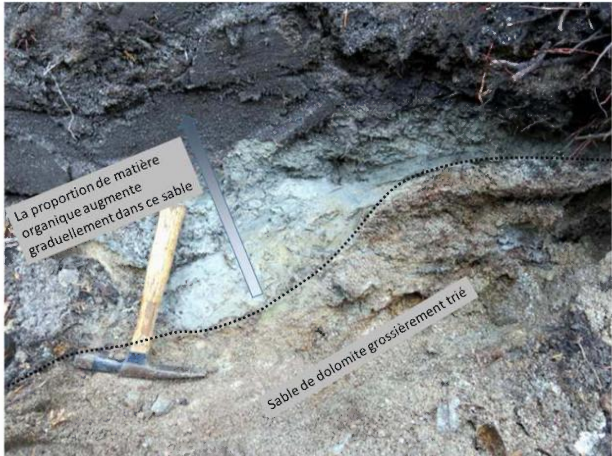
Figure 26: Coupe du sol, à cinq mètres au Nord de la tranchée Sonny-14-01, montrant le sable dolomitique, produit par la dissolution de la sphalérite, repris par l'érosion fluvio-glaciaire. Ce sable montre des stratifications entrecroisées frustes. Il passe graduellement, vers le haut, à un sable fin qui se gorge progressivement de matière organique noire. Il s'agit là du profil de sol de la zone marécageuse qui se situe immédiatement en aval-pendage de la minéralisation zincifère que nous avons dégagée par tranchées (cf. Figs. 10 et 11).
