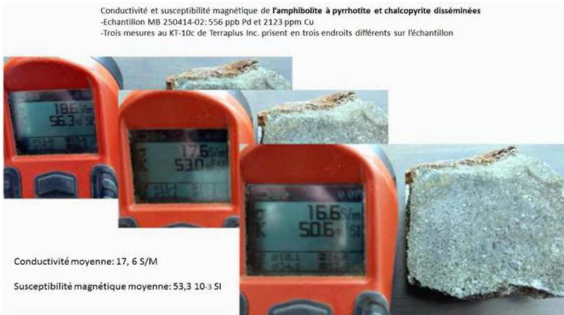
Figure 28: Conductivité et susceptibilité magnétique de l'amphibolite à pyrrhotite et chalcopyrite disséminées du gîte Meilleur.
