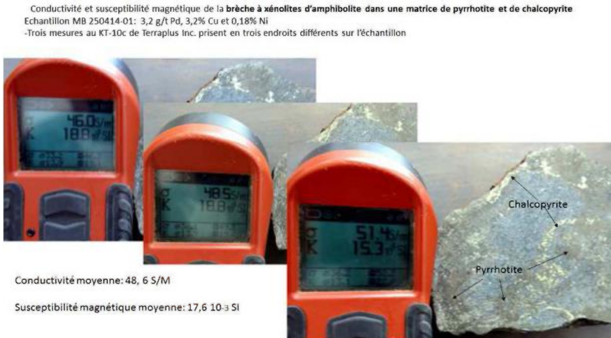
Figure 29: Conductivité et susceptibilité magnétique de la brèche à xénolites d'amphibolite dans une matrice de pyrrhotite et de chalcopyrite.
