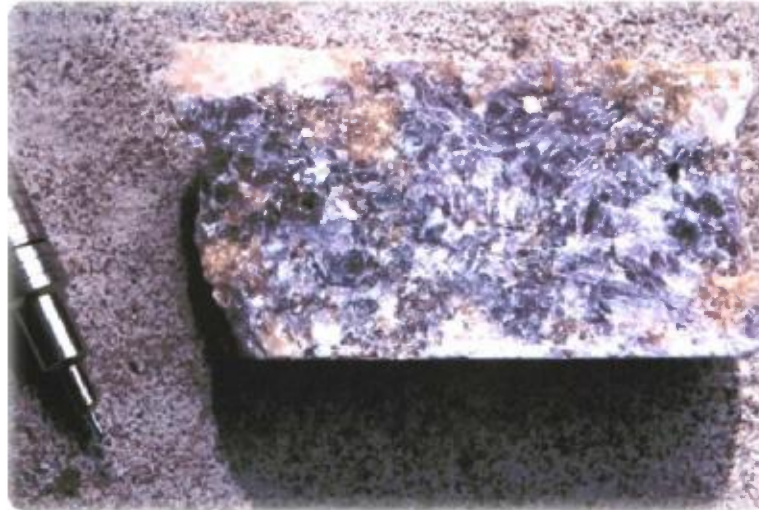
Figure 13 : Méta-évaaporite (i.e. anhydrite de couleur lavande) recoupée par les forages profonds implantés dans les années 1990 par Explorations Noranda Inc. dans les marbres dolomitiques du gîte de zinc Cadieux (Soever et Meusy, 1987). Ce gîte est situé à trente kilomètres au Sud de la mine New Calumet où Brown (1973) rapporte de l'anhydrite en tout point semblable à celle du district minier de Balmat (N.Y.) (Fig. 11).
