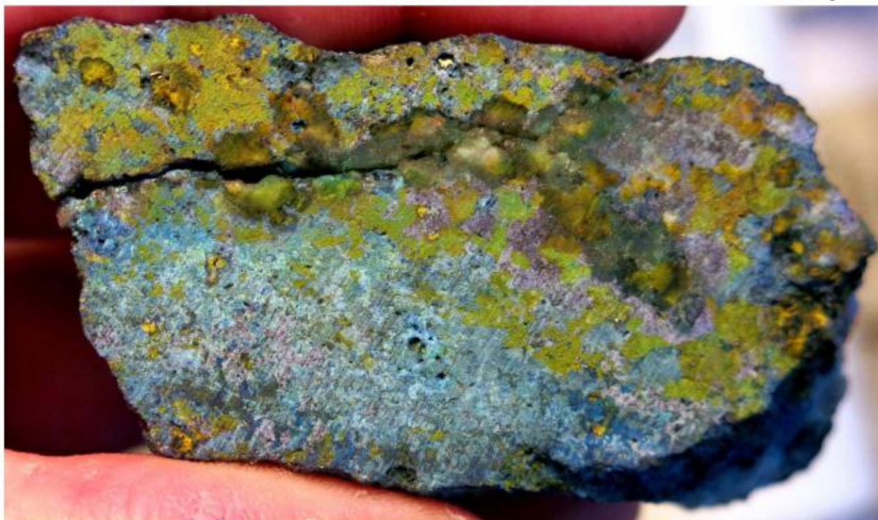
Fig. 8. Coloration au bleu de méthylène, en bleu, de la néphéline contenue dans la roche de la figure 6. Notez les microcavités dans cette roche. Secteur Nasigon Sud-Est (491409E / 5263981N, Nad 83, UTM 18).
