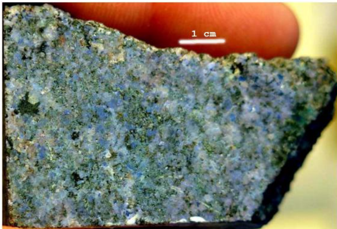
Fig. 23. Coloration au bleu de méthylène de la néphéline contenue dans le gneiss fenitisé en syénite du secteur Nasigon Nord-Est (491735E / 5265042N, Nad 83, UTM 18).
