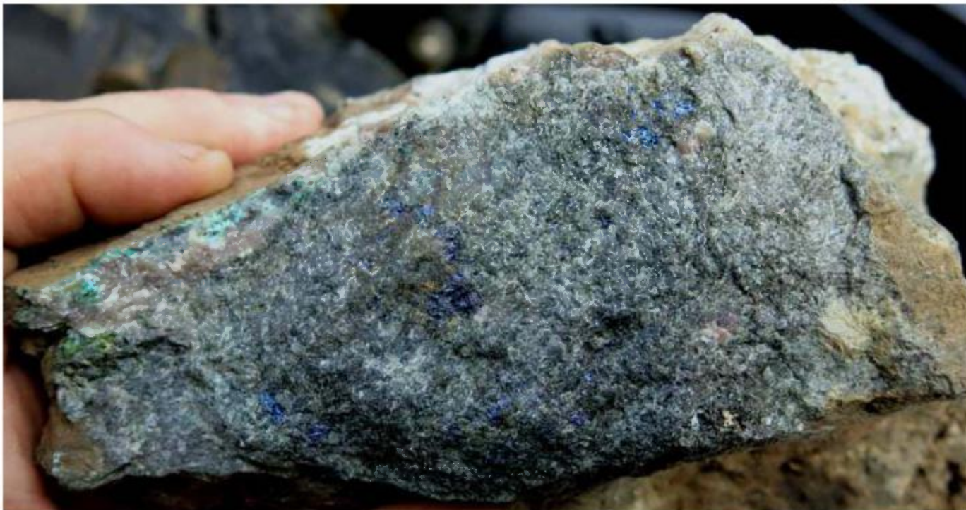
Fig. 28. Grains composites de bornite-chalcocite/digénite-covellite dans une roche à diopside, trémolite, calcite, scapolite et phlogopite du secteur Nasigon Nord-Est (localité-type : 491735E / 5265042N, Nad 83, UTM 18)
