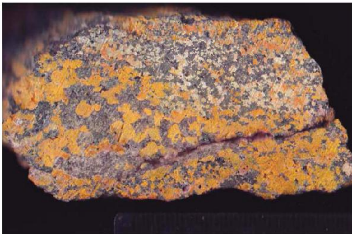
Fig. 7. Coloration au cobaltinitrite, en jaune, des feldspaths potassiques de la roche de la figure 6. Secteur Nasigon Sud-Est (491409E / 5263981N, Nad 83, UTM 18).
