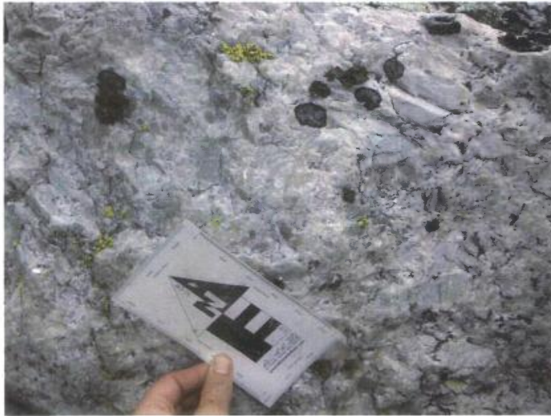
Figure 12 : Un bloc plurimétrique de pegmatite avec 15% de spodumène blanc de 4-6 cm, a retourné 2,25% \text{Li}_2\text{O}
