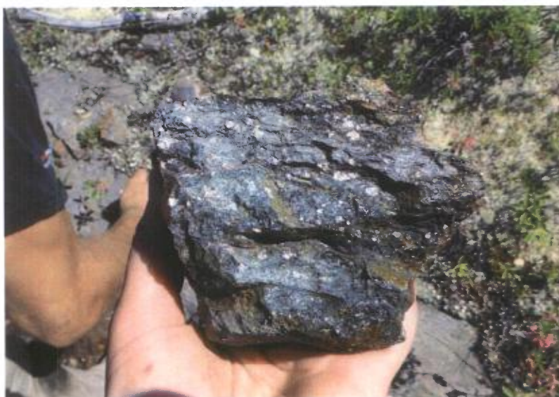
Figure 8 : Échantillon de metabasalte avec nodules d'arsénopyrite ayant retourné des valeurs en or
