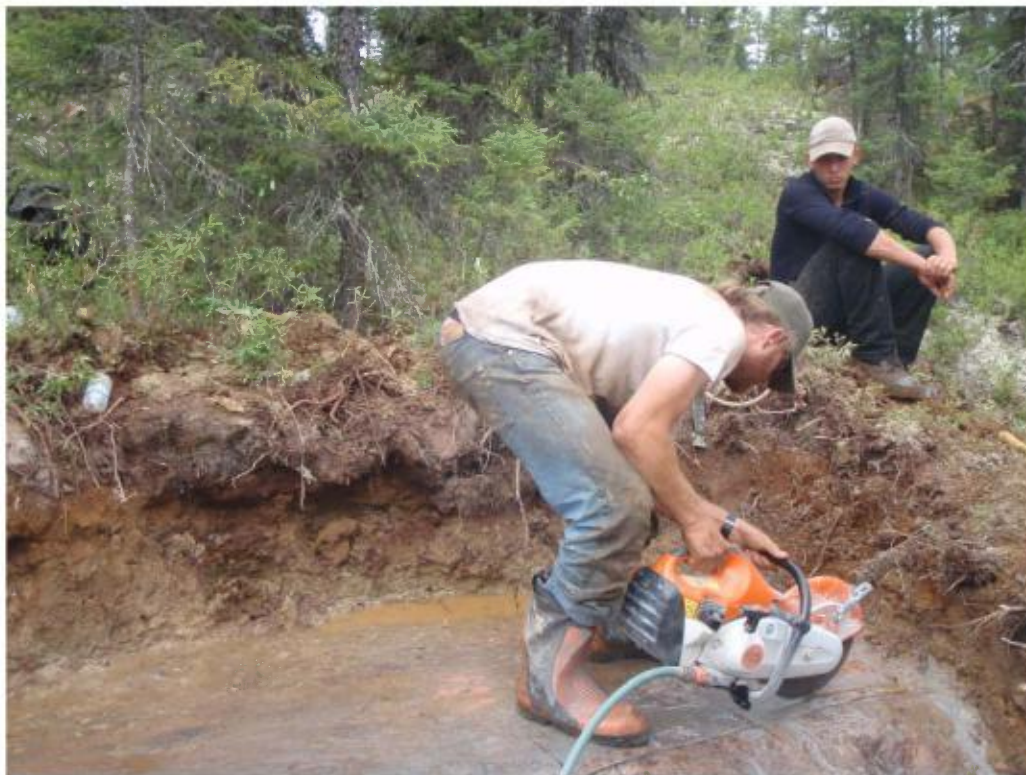
Figure 19: Rainurage avec scie à roche
