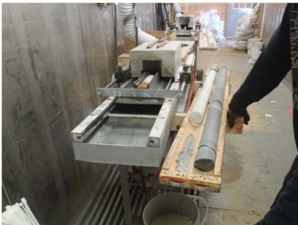
Figure 20: Scie à carotte de forage
