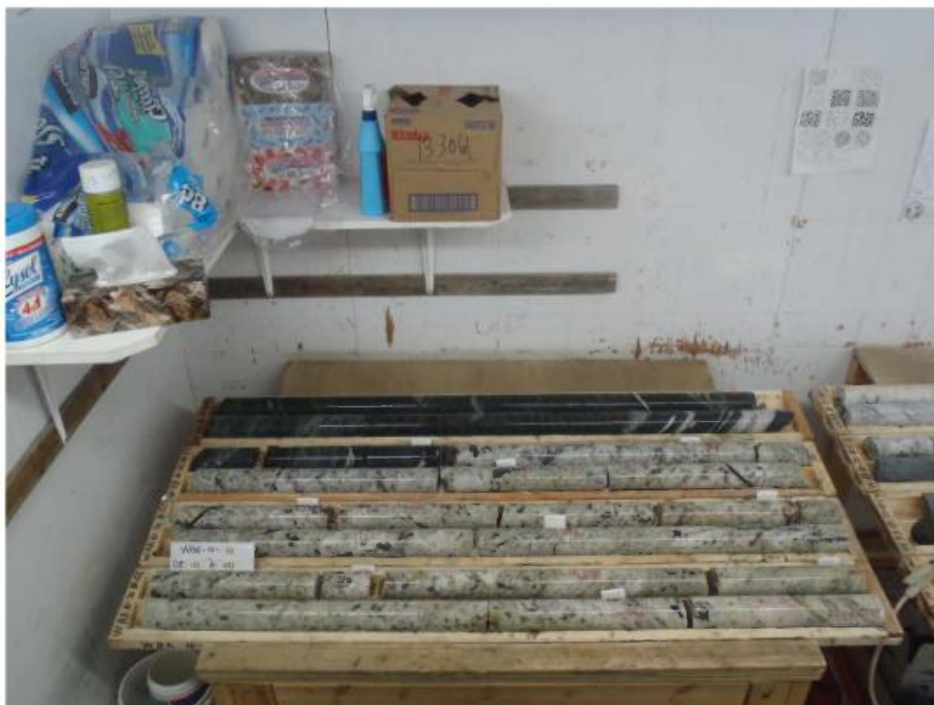
Figure 21: Échantillonnage carotte de forage
