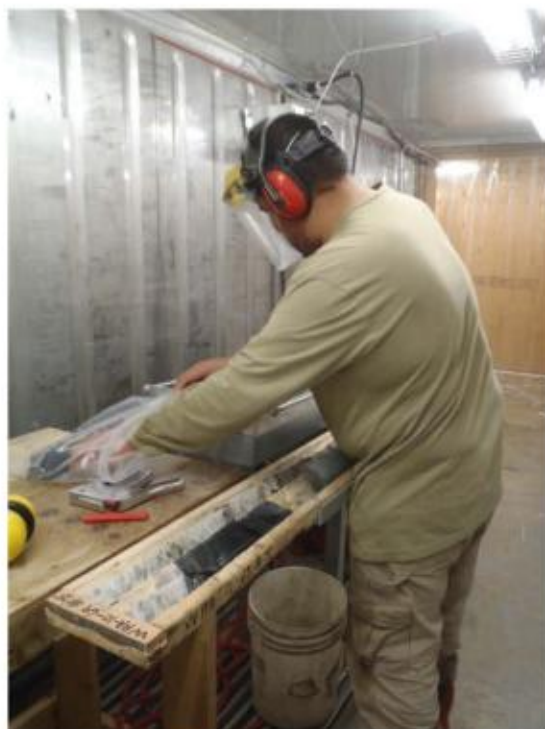
Figure 22: Ensachage échantillon de forage
