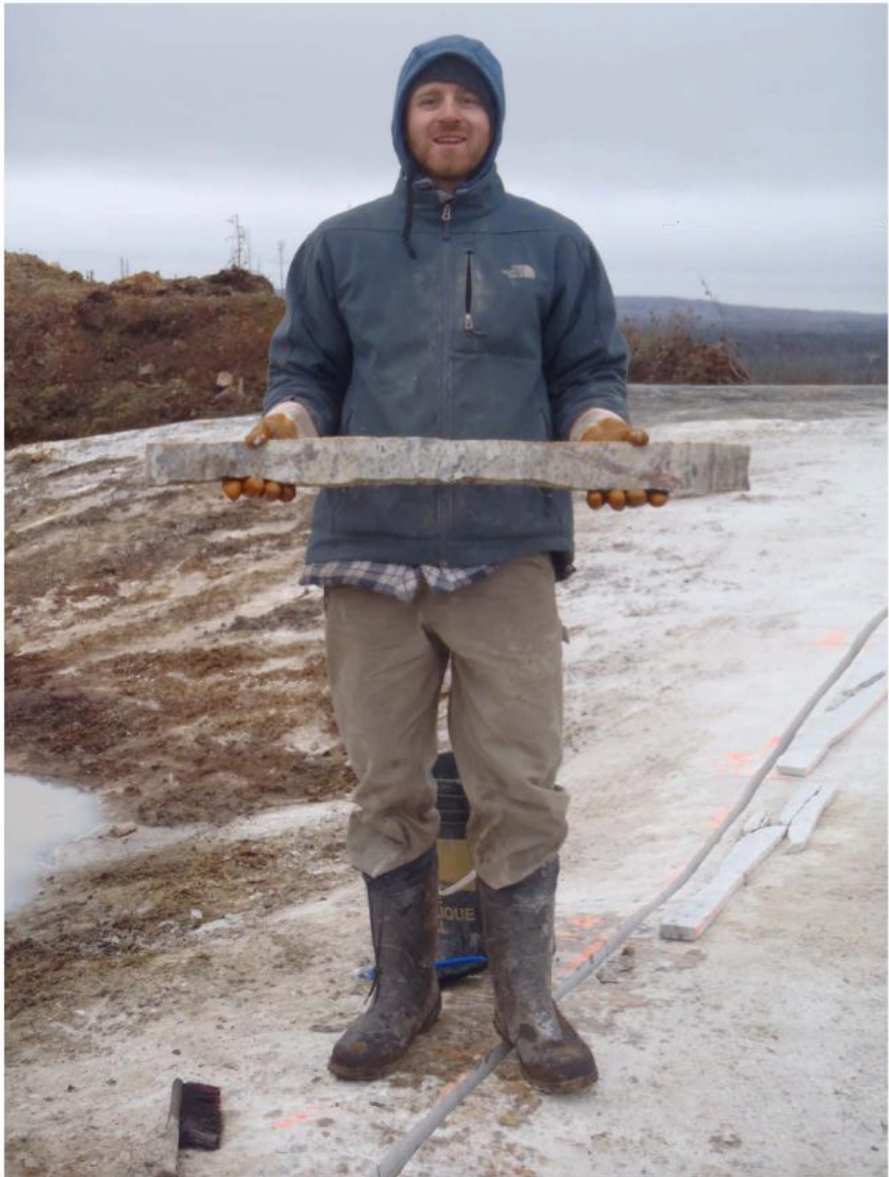
Figure 18: Échantillon de rainure
