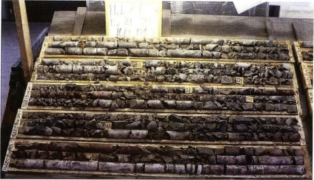
Photo 15 : Carbonatite dans le trou 773-11 (C) pouvant correspondre à une zone de faille.
