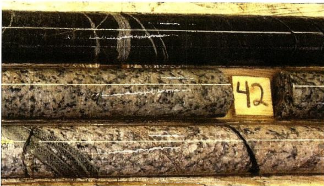
Photo 6 : Exemple de lamprophyre (36,85 à 40,85 m, trou 773-17 (K)), massif recoupé par des veines et veinules de carbonate.
