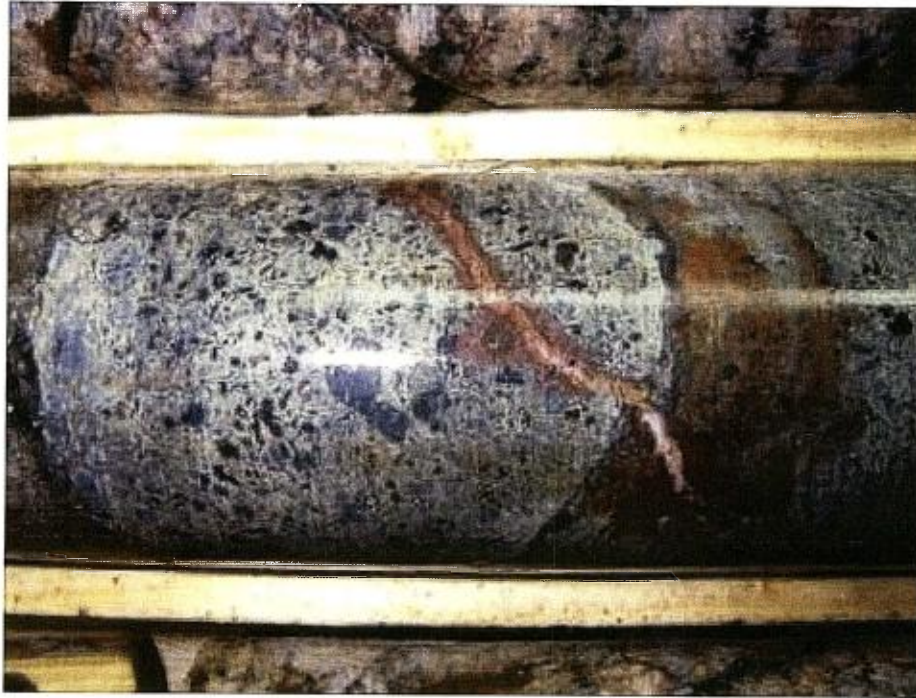
Photo 5 : Exemple de lamprophyre (32,25 m, trou 773-15 (HH2)) à texture mégacristalline.
