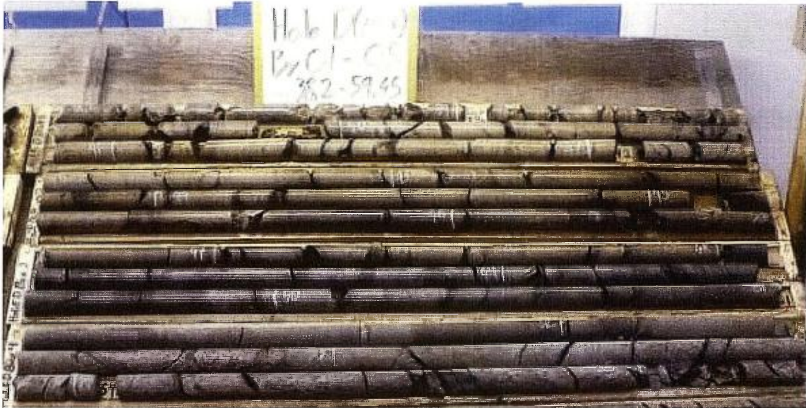
Photo 12 : Niveau de calcaire de la Formation de Simard dans le trou 773-10 (D).
