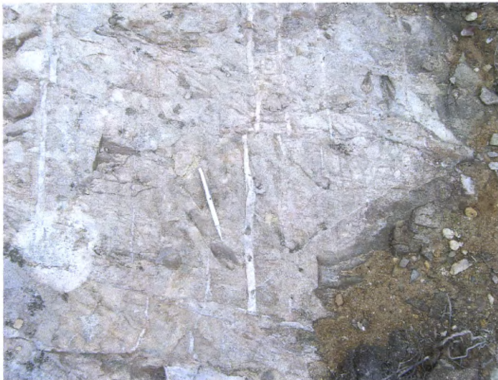
Évidences de structures cassantes avec déplacement dextre des veines de quartz.
