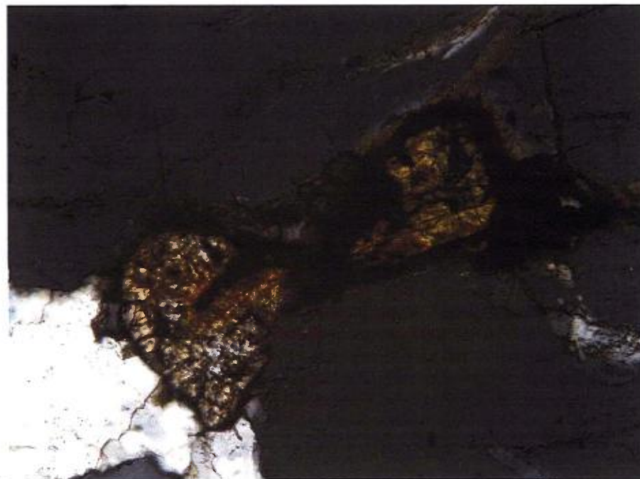
Photo 31 : Vue d'un grain complexe de zircon métamicté, enchâssé dans du quartz (LA, cdv : 0,7 mm).
