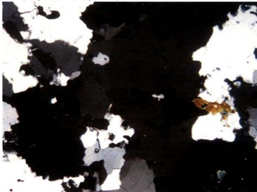
Photo 6 : Vue d'une plage de quartz formée de grains équants aux bordures suturées, et enchâssant des petits grenats (gris foncé) xénomorphes (LA 4 ; cdv : 2,8 mm).
