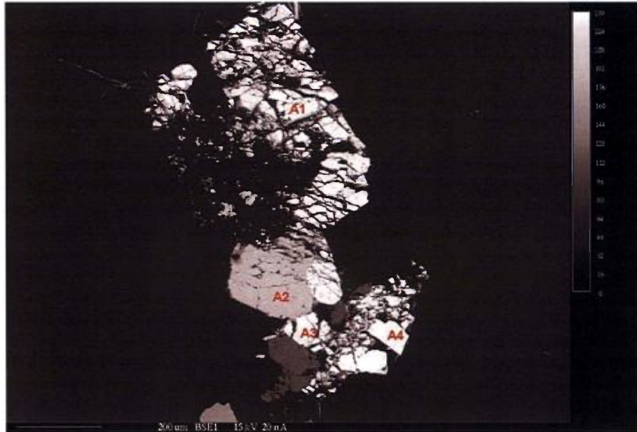
Photo 46 : Vue en électrons rétrodiffusés de l'image 45A montrant plusieurs grains d'uraninite à forte densité atomique (points A1, A2 et A4) et le grain A2, enrichi en thorium.
