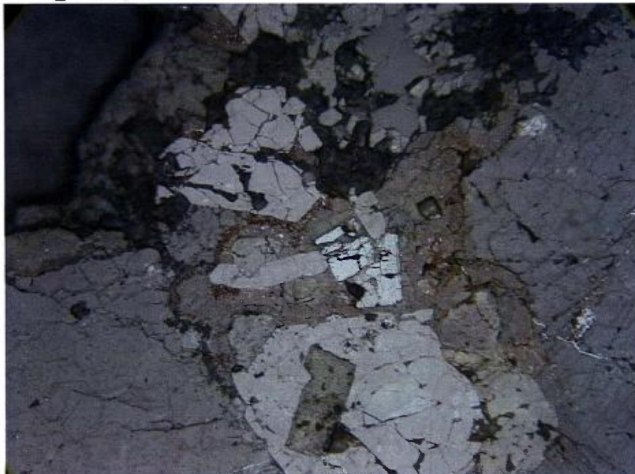
Photo 39 : Vue agrandie en lumière réfléchie de l'image 38 montrant la différence de réflectance entre l'uraninite et la phase thorifère (LR; cdv : 0,7 mm).
