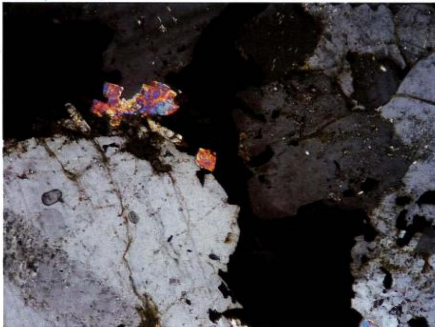
Photo 37 : Vue d'une plage de pyrrhotite interstitielle associée à des petits zircons prismatiques et à des paillettes (colorées) de muscovite. Les minéraux encaissant sont dominés par l'albite trouble (LA; cdv : 1,4 mm).
