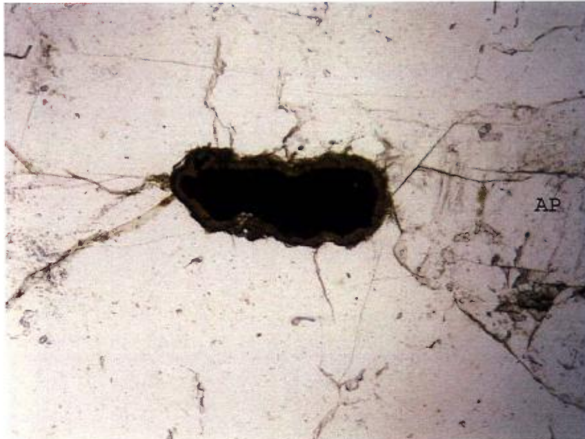
Photo 7 : Vue d'un grain d'uraninite (?) enchâssé dans le quartz. On note la couronne de minéraux secondaires jaunâtres et les fractures radiales et l'apatite (AP) (LP, cdv : 1,4 mm).
