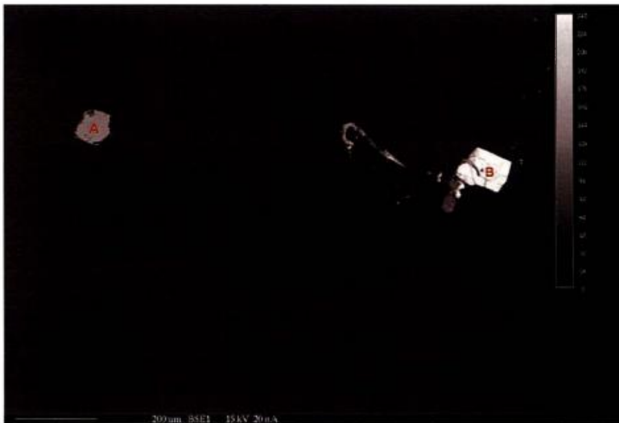
Photo 49 : Vue en électrons rétrodiffusés des grains de la zone C4 montrant un grain de sulfure (A) et le grain d'uraninite (B). Notez la différence de luminosité causée par la différence de densité atomique.
