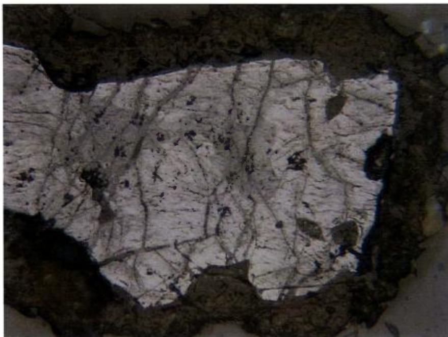
Photo 9 : Vue détaillée du grain d'uraninite en lumière réfléchi, montrant le détail de l'altération interne. La nature des différentes phases n'est pas établie (LR; cdv : \pm 0.5 mm).
