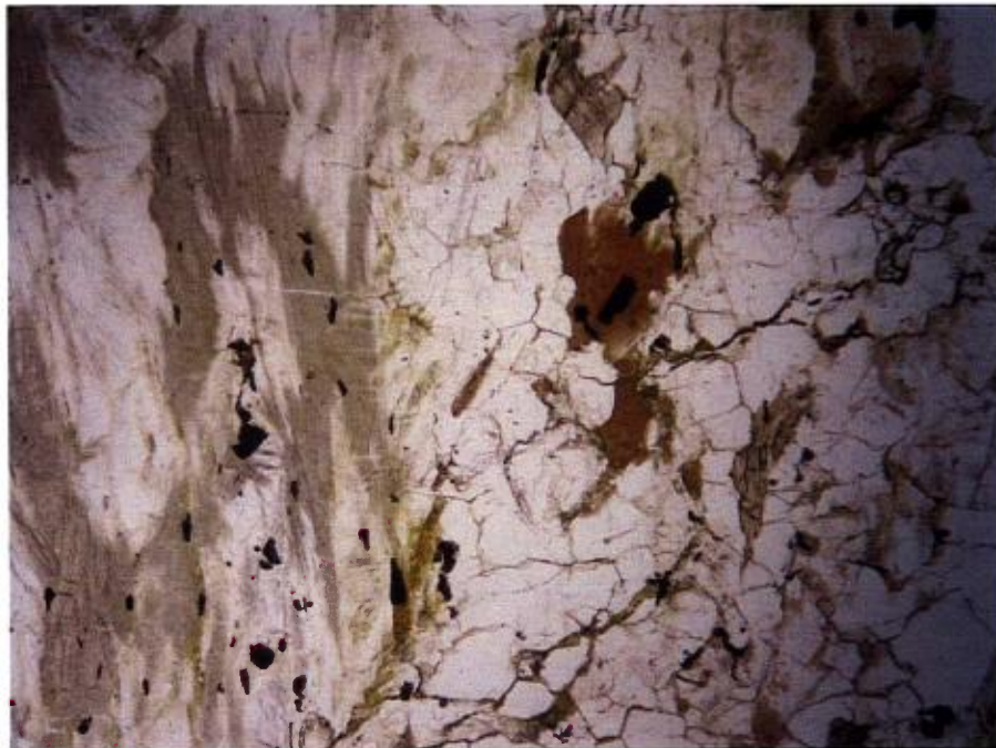
Photo 53 : Vue générale du paraschiste montrant un lithon quartzofeldspathique à biotite à droite, et un lithon à sillimanite et cordiérite? à gauche (LP, cdv : 2,8 mm).
