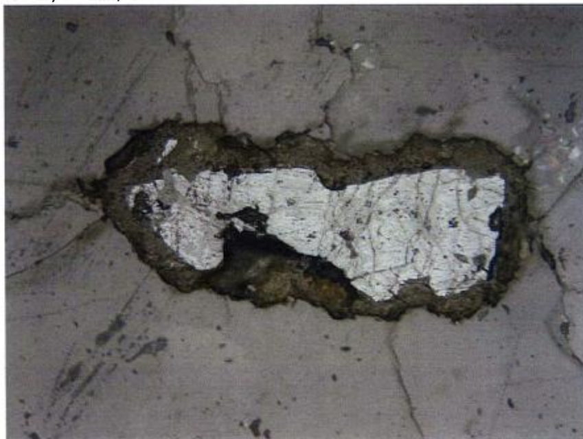
Photo 8 : Vue détaillée en lumière réfléchie du grain d'uraninite. On note les altérations internes (LR 5 ; cdv : 0,7 mm).
