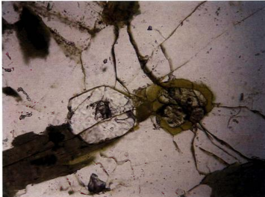
Photo 11 : Apatite (claire), zircon et biotite. Notez les halos pléochroïques (LP, cdv : 0,7 mm).
