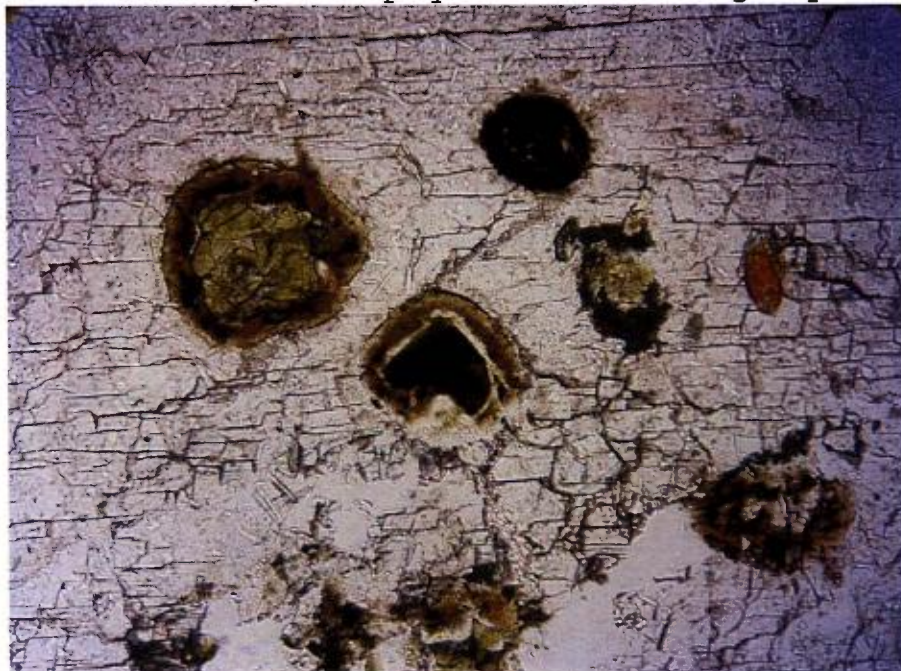
Photo 41 : Vue de la zone C2 montrant une série de grains divers bordés d'halos d'altération vérifiés à la microsonde. On note que certains sont opaques et d'autres constitués d'un cœur jaune altéré (LP, cdv : 0,7 mm).
