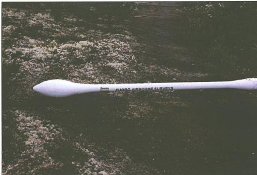
Figure 4: Capteur Césium en bout de perche rigide
