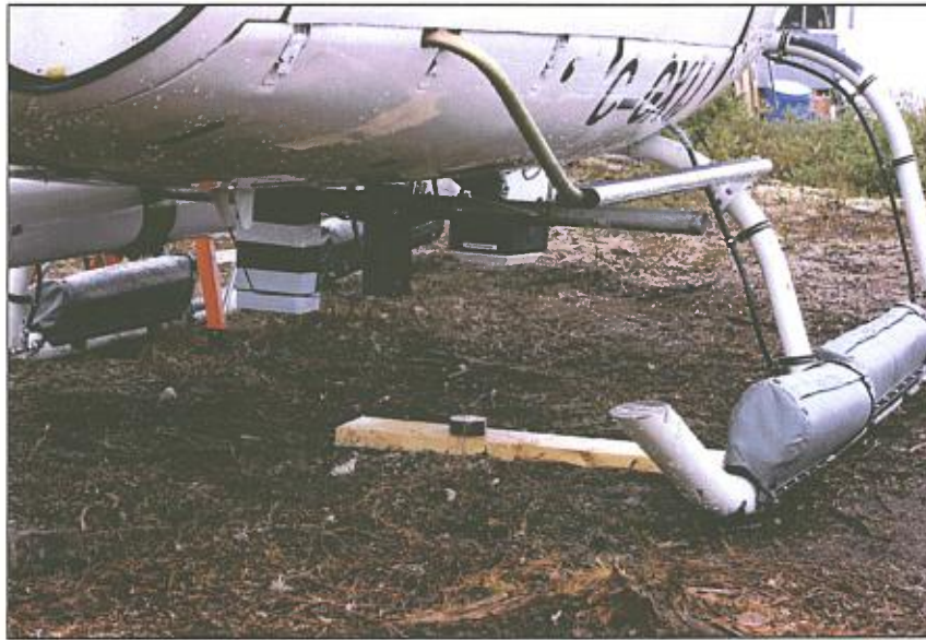
Figure 6 : Altimètres radar, laser et caméra vidéo sous l'hélicoptère
