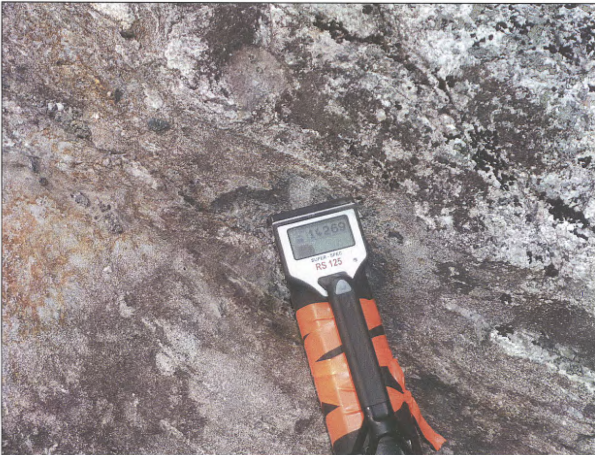
Figure 4 : Photo illustrant une anomalie scintillométrique (14269 cps) dans le paléosome d'une migmatite. Secteur correspondant à la zone d'échantillonnage de l'échantillon 5519724 à 0.636% U_3O_8 et de l'échantillon 55190050 à 0.174% U_3O_8 .
