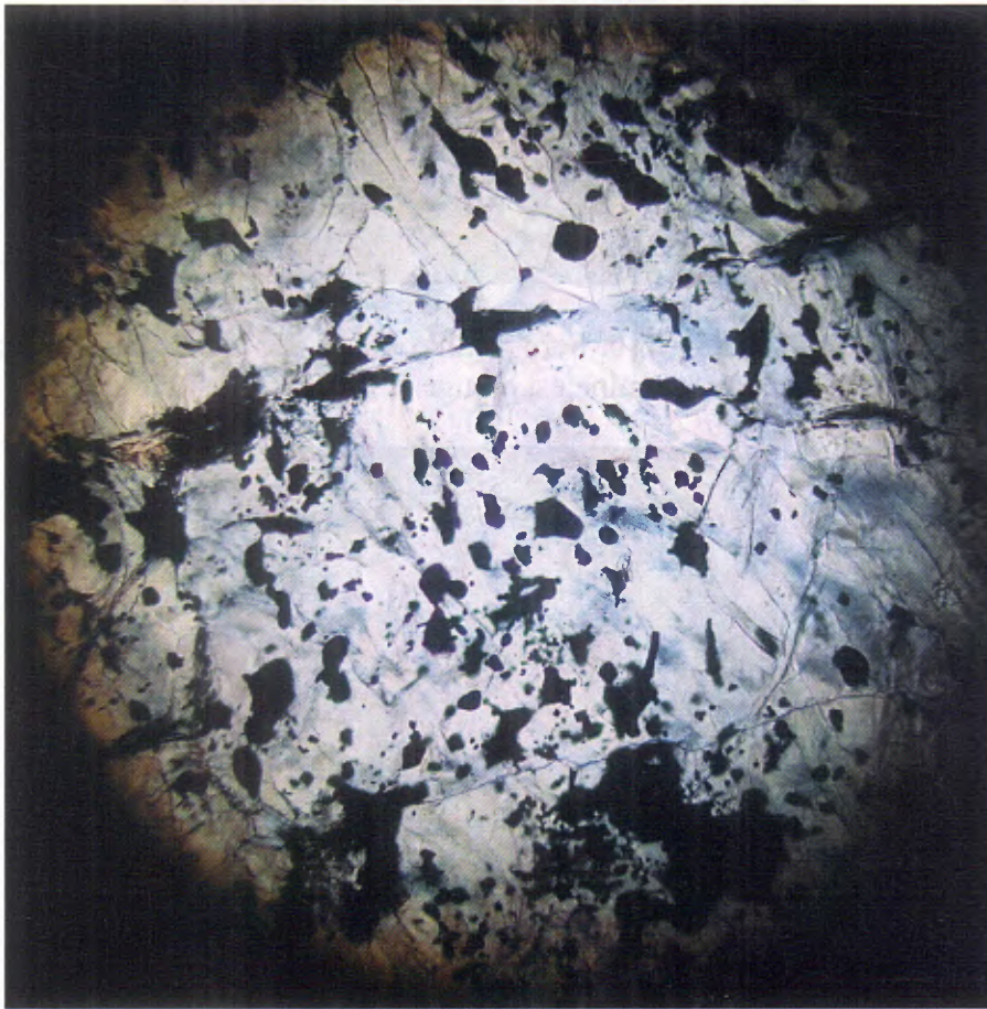
Photo 1: LM TF-07-07. LN – X10. Serp + Chlo avec nombreuses inclusions de minéraux opaques composés essentiellement de magnétite et de pyrrhotine ( voir la photo 10 ). La serpentine montre un pléochroïsme jaunâtre, tandis que la chlorite est bleu-grise et contient donc du fer (chlorite ferro-magnésienne).
