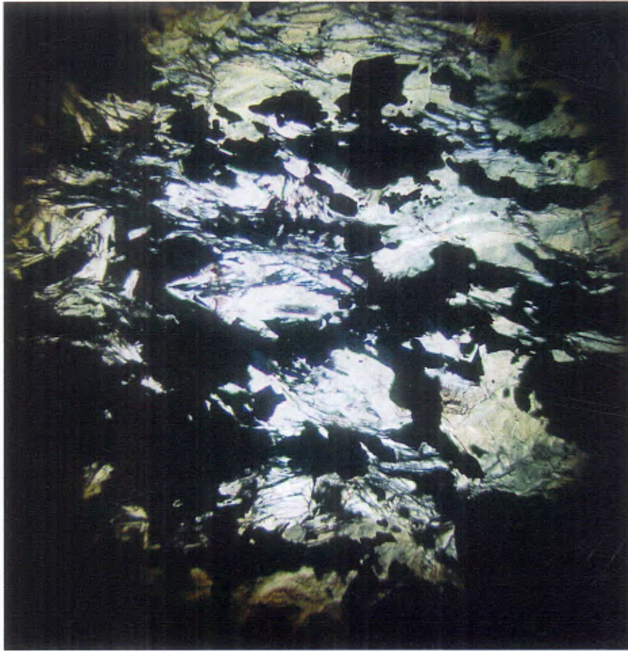
Photo 5 : LM TF-07-07. LP – X5. Chlo + Serp avec sulfures disséminés à semi-massifs. Les feuillets de chlorite sont allongés. La serpentine montre une couleur jaunâtre tandis que la chlorite est incolore ce qui caractérise une chlorite magnésienne.
