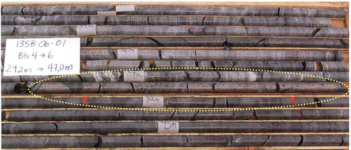
Figure 8 : zone minéralisée à sulfures massifs (zone pointillé jaune); on remarque les clastes de basalte dans la pyrrhotite massive (flèche rouge); trou 1358-06-01, boîtes 4 à 6; 40,25 m à 41,1 m.
