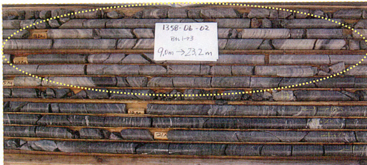
Figure 6 : Gneiss felsique (dans la zone pointillé jaune); trou 1358-06-02, boîtes 1 à 3; 9 m à 23,2 m
