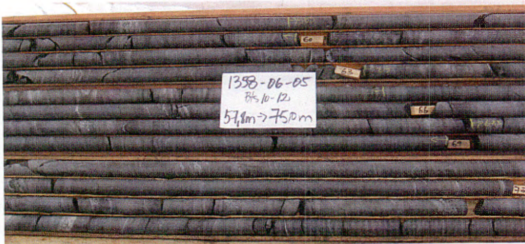
Figure 5 : Basalte amphibolitisé; trou 1358-06-05, boîtes 10 à 12; 57,8 m à 75,0 m.
