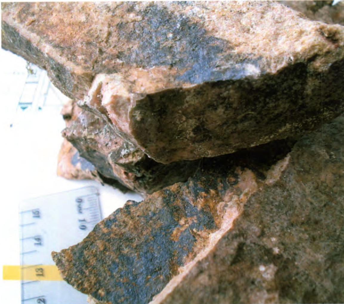
Photo 2 : Plaquage d'hématite dans fractures de la syénite.
