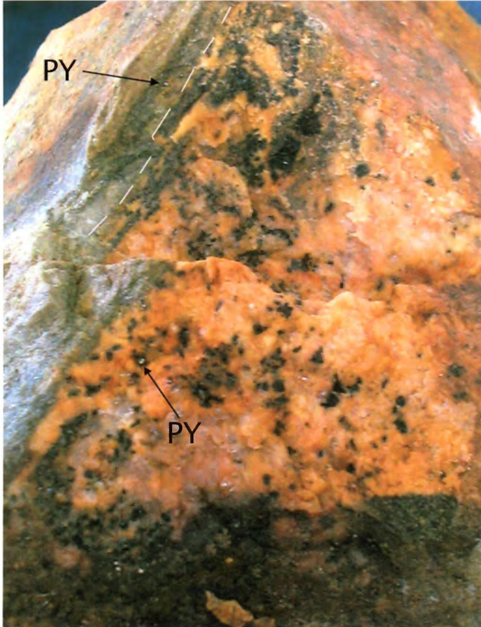
Photo 4 : Grains de pyrite (PY) au contact d'une enclave (Form. Daubrée, à gauche) et de la syénite (à droite). Échantillon PA-04-707, Dome Hill.
