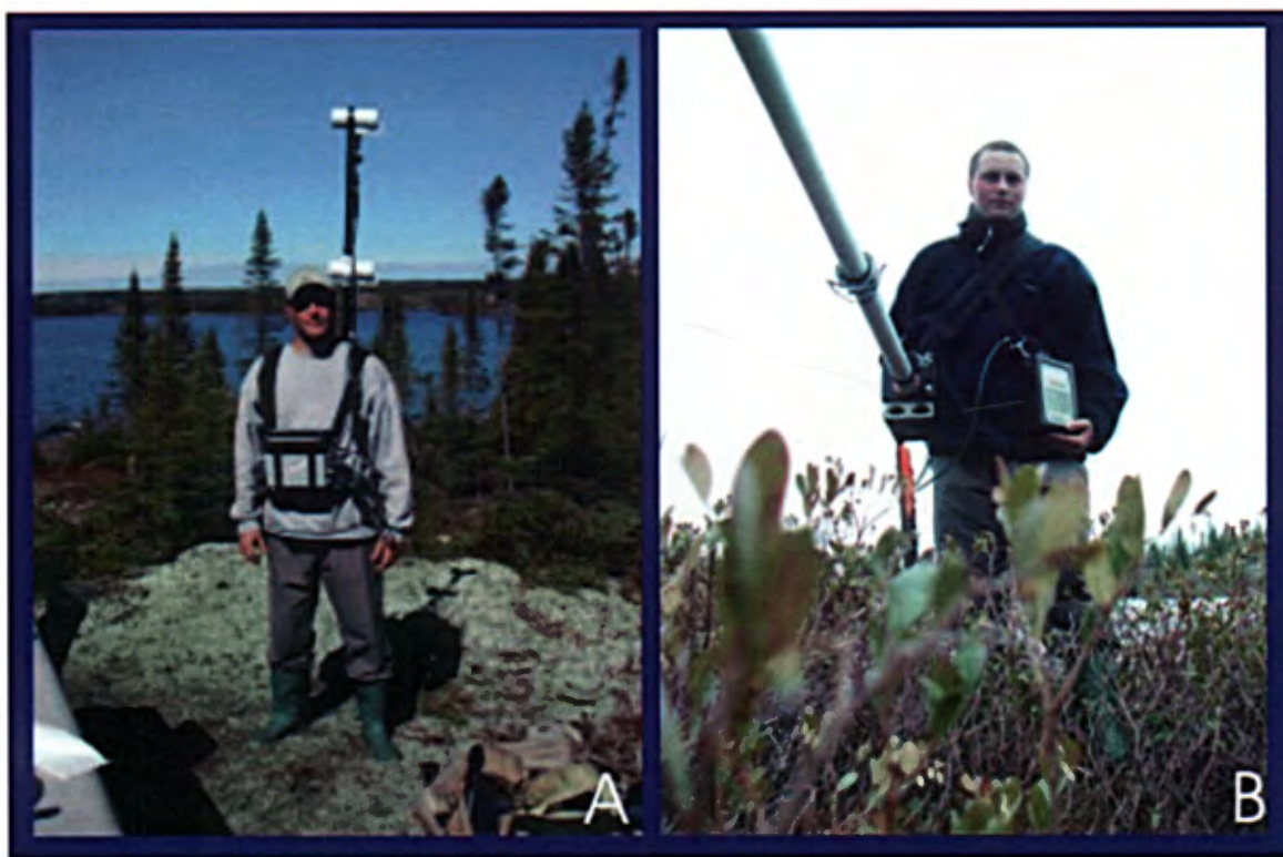
Figure 37. Équipement de géophysique utilisé sur le terrain. A) Magnétomètre-gradimètre GSM-19 WG et B) Sonde d'induction électromagnétique EM-31 de Geonics. Opérateur: Bruno Boussicault
