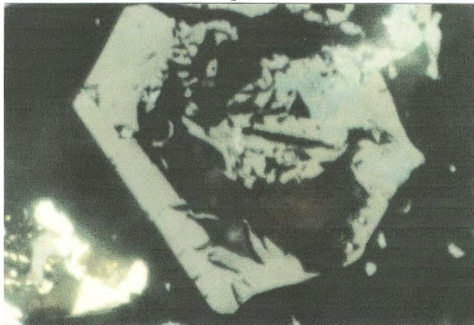
PHOTO 18: Vue en immersion d'un grain squelettique de titanomagnétite enchâssant quelques grains de rutile (plus clair), sur la section 261-1. La plage très lumineuse est une petite pyrite. La plage lumineuse gris bleuté est une anatase (OELR, 1250x).
