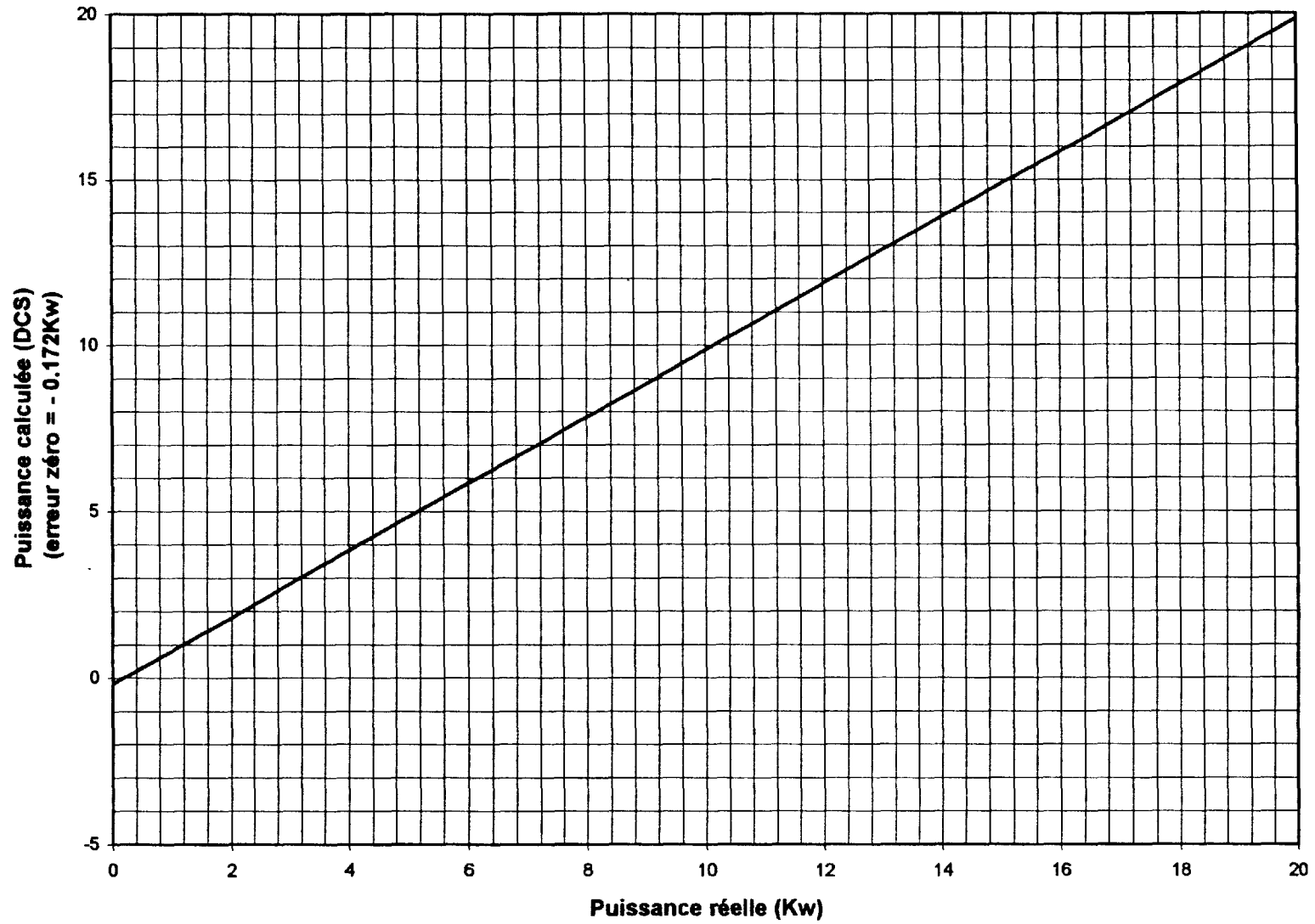
Figure 2 : Puissance réelle (torquemètre) vs puissance calculée (DCS) (vitesse : 1990 rpm) (17/03/98)
