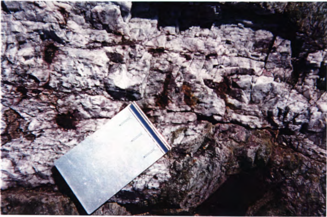
Photo 5 : Vue d'une veine de quartz de l'indice Brèche-167, contenant des nodules de pyrrhotite et chalcopyrite aurifère.
