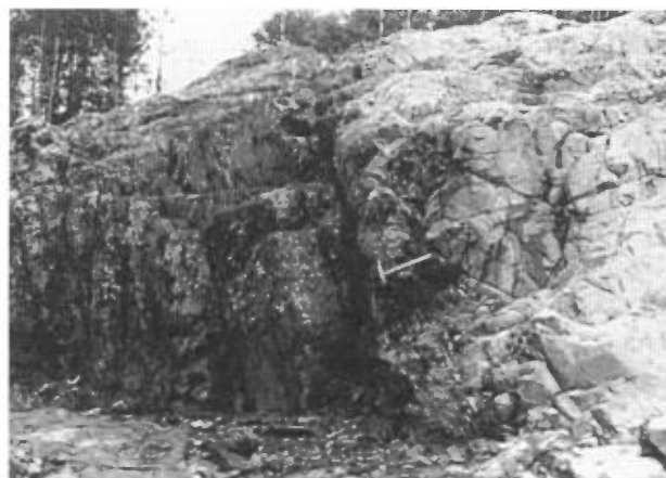
FIGURE 25 – Exemple d'une zone d'altération et de mylonitisation (roches plus sombres) le long d'une faille (juste à gauche du marteau). Indice Agar 2 (figure A.3 de l'annexe A). Le marteau fait 35 cm de longueur.
