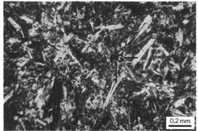
FIGURE 15 — Photomicrographie en lumière polarisée d'un échantillon de basalte tholéiitique (unité Bba) du Groupe de Povungnituk, Sous-groupe de Beuparlant. Notez la présence de microlites de plagioclase (PG) sous la forme d'aiguilles enchevêtrées.
