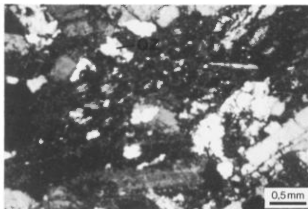
FIGURE 38 — Photomicrographie en lumière polarisée d'un échantillon de ferrogabbro à quartz (unité 2). Notez les grains xénomorphes de quartz (QZ).
