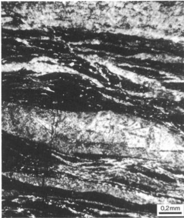
FIGURE 22 — Photomicrographie en lumière polarisée d'un échantillon d'ardoise ferrugineuse (unité Bffe) du Groupe de Povungnituk, Sous-groupe de Beauparlant. Notez l'alternance de lits ferrugineux (noirs) et de lits riches en minéraux micacés (plus pâles).
