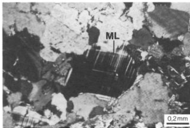
FIGURE 4 — Photomicrographie en lumière polarisée d'un échantillon de granite de l'unité de granite (Pgra). Notez la présence de grains de microcline (ML) montrant la maclure polysynthétique.
