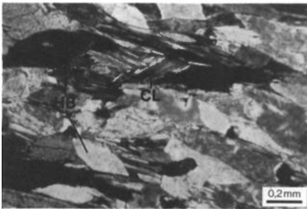
FIGURE 6 — Photomicrographie en lumière polarisée d'un échantillon de schiste à amphibole (enclave mafique de l'unité de granodiorite-tonalite ou granite [Pgem]). Notez la présence de cristaux automorphes de hornblende (HB) et d'aiguilles de chlorite (CL).
