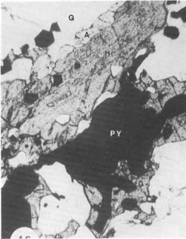
FIGURE 32— Bande composée de quartz (Q), d'hypersthène (H), de grenat (G), de pyrite (PY) colliforme (remplaçant le grenat) et d'apatite (A). Lumière transmise (40X). Tirée de Kieller & Wilhelmy, 1986.
