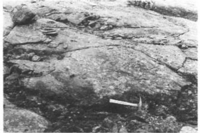
FIGURE 39— La présence d'un contrôle structural de la minéralisation peut être soupçonnée ici. Le cisaillement (en ligne avec le marteau) semble favoriser la minéralisation, ou tout au moins la rouille.
