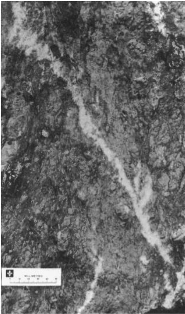
FIGURE 58 — Dolomie calcaireuse à texture cataclastique. Indice Bravo.
