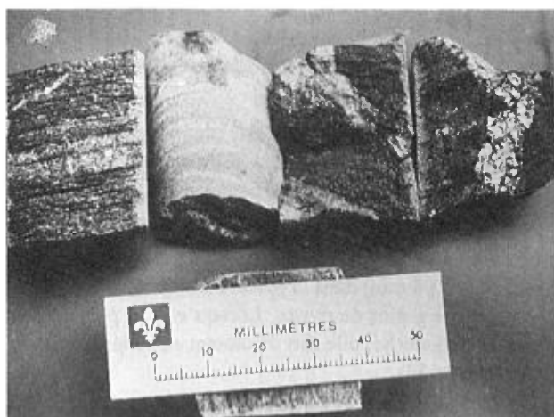
FIGURE 50 – Veine de quartz et de pyrite suivant et recoupant de façon irrégulière la schistosité S_1 (Zone Lepage, forage JV-75-6, 47,1 m).
