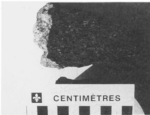
FIGURE 13 – Pyroxénite minéralisée provenant de la surface de la zone Lepage. Les grains de pyroxène sont entourés par les sulfures et intercumulus (texture en filet).
