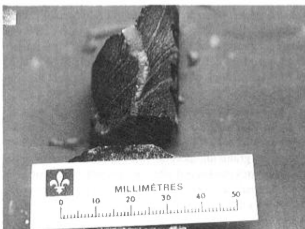
FIGURE 49 – Veine de quartz remplissant une zone de cisaillement transverse à la schistosité S_1 , qui est légèrement déplacée (Zone Lepage, forage JV-74-6, 51,4 m).
