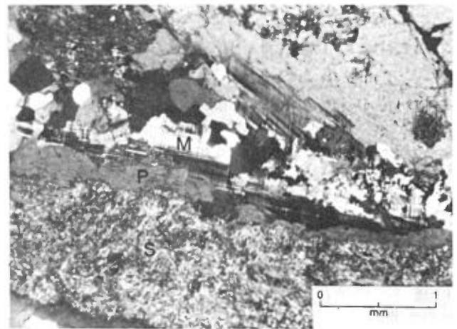
FIGURE 27 – Photomicrographie d'une diorite quartzique montrant un phénocristal de plagioclase (P) dont le coeur est séricitisé et saussuritisé (S). La bordure du cristal est partiellement remplacée par le microcline (M). Lumière polarisée. Échantillon dont l'analyse apparaît au tableau 10. Près de la limite ouest de la région.
