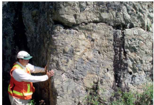
PHOTO 13.4 - Andésite basaltique coussinée de la Formation de Daniel (unité nAdnl) avec stratification subhorizontale, Plaine Centrale. Face verticale orientée N-S, la polarité est vers le haut. Affleurement 2011-PL-417, feuillet 32F13.
