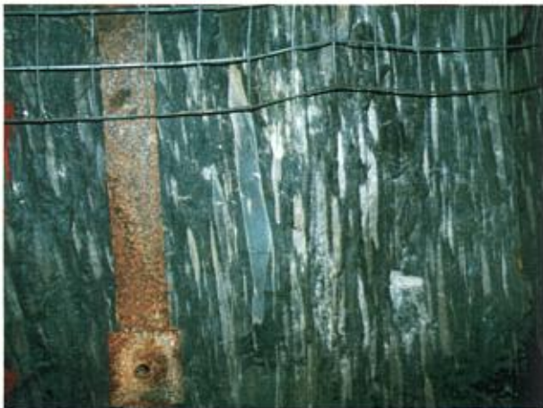
Photo 27 - Déformation des fragments de brèche dans la schistosité principale Sp avec fort étirement apparent dans le plan perpendiculaire à Sp. Galerie 20-74, niveau 86. Bande de métal de 12 cm de largeur.
