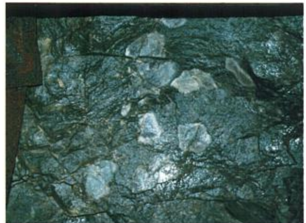
Photo 28 - Déformation des fragments de brèche de coulée dans le plan de la schistosité principale Sp avec aplatissement plutôt qu'étirement. Galerie 20-31, niveau 86. Plaque de métal de 12 cm de largeur.
