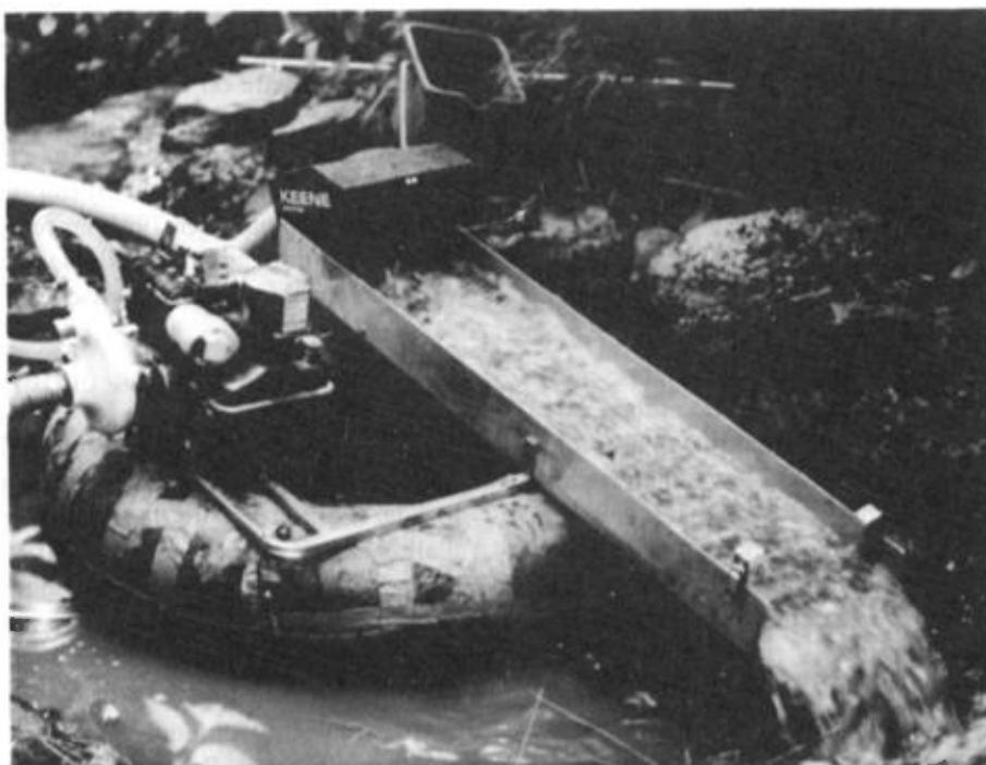
FIGURE 1 - Drague à sluice.
