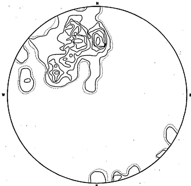
FIGURE 4 - Stéréogramme des plans de recristallisation des quartz dans la trondhjémite. 45 mesures. Isocourbes aux 2% (maximum de 12%).
