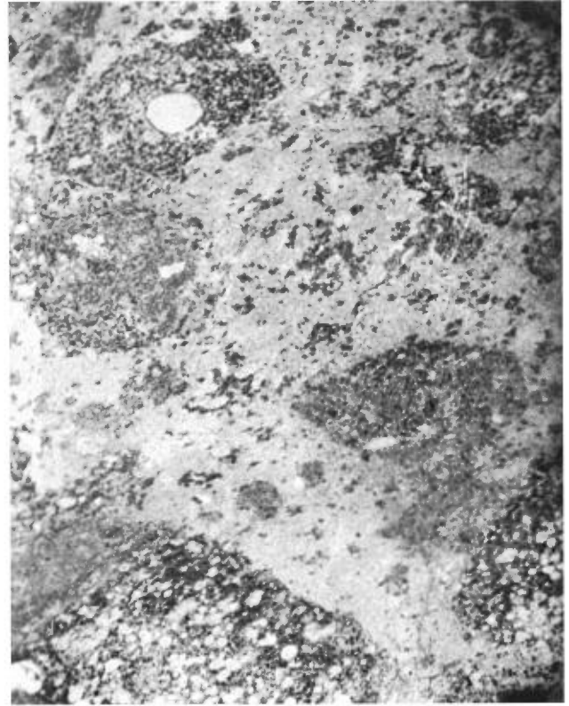
FIGURE 31 - Photographie de lame mince entière montrant l'hétérogénéité de composition et les éléments nodulaires. Lumière naturelle. 2X.
