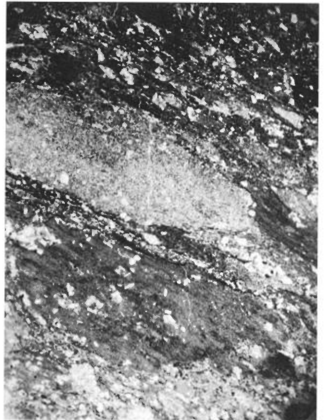
FIGURE 45 - Photographie de lame mince entière montrant des éléments allochtones cimentés par un tuf basique. Lumière naturelle. 2X
