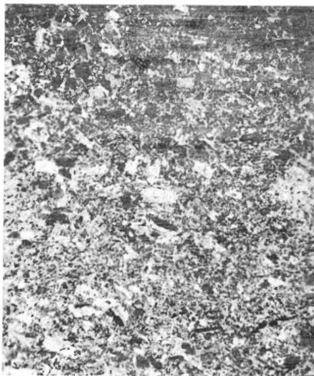
FIGURE 50 - Photographie de lame mince entière montrant la texture d'une granodiorite à plagioclase zoné. Lumière naturelle. 2X.
