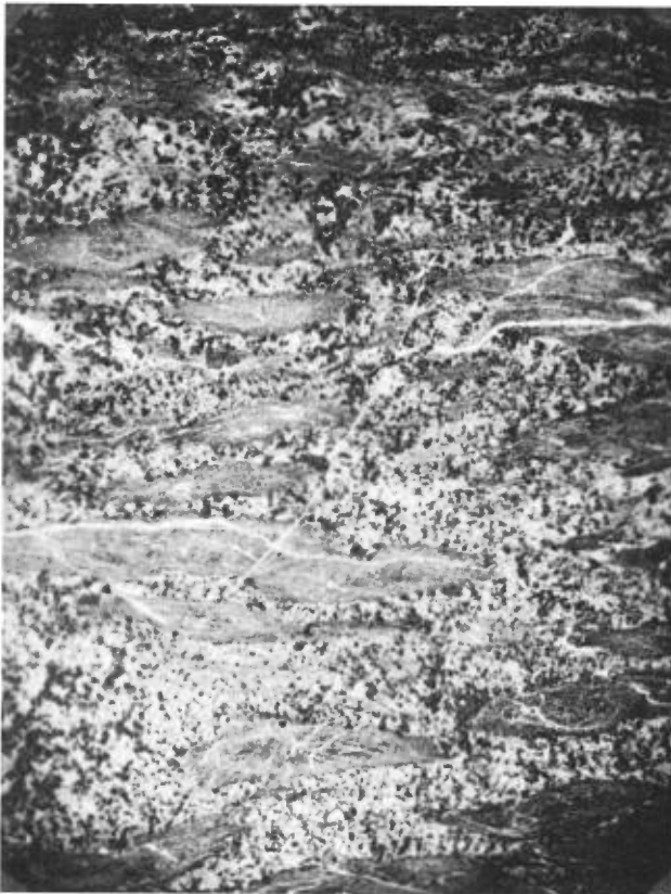
FIGURE 44 - Photographie de lame mince entière montrant des noyaux étirés riches en épidote dans une matrice basique. Lumière naturelle. 2X
