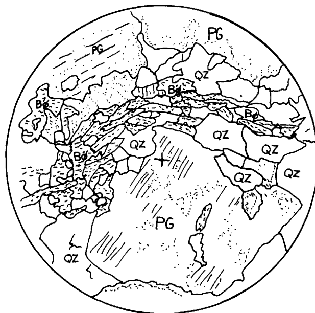
FIGURE 17 - Dessin d'une lame mince (CD-188-74) représentant une trondhjémite. Agrégat de petits cristaux de biotite dans une matrice constituée principalement de plagioclase et de quartz à contours allotriomorphes.
