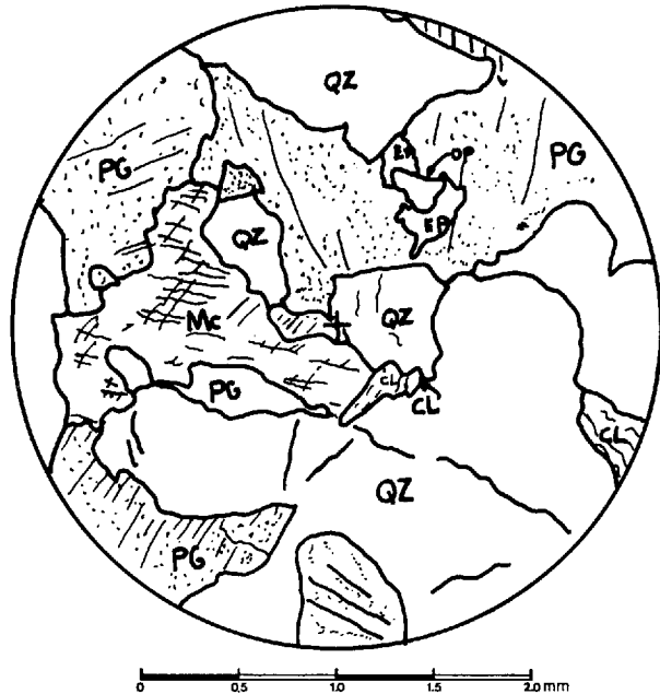
FIGURE 11 - Dessin d'une lame mince (CD-162-75) représentant une granodiorite porphyroïde. Le microcline semble postérieur et se présente sous forme interstitielle ou en phénocristaux souvent poeciloblastiques.
