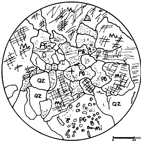
FIGURE 4 - Dessin d'une lame mince (CD-06-74) représentant une monzonite quartzique. Le plagioclase est partiellement saussuritisé. Le microcline est frais et montre une structure indentée. Présence de myrmékite. Secteur IV, lac Jolliet.
