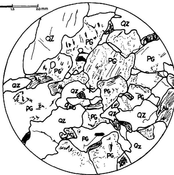
FIGURE 17 - Dessin d'une lame mince (CD-188-74) représentant une trondhjémite. Agrégat de petits cristaux de biotite dans une matrice constituée principalement de plagioclase et de quartz à contours allotriomorphes.
