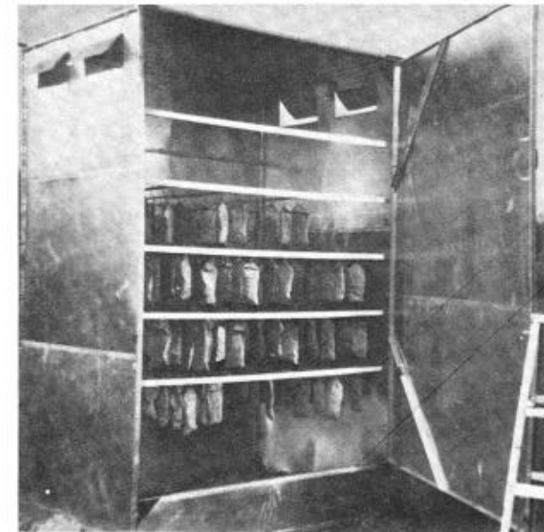
FIGURE 12 - Four à gaz en aluminium pour le séchage final des échantillons. (Photo J.P. Lalonde).
