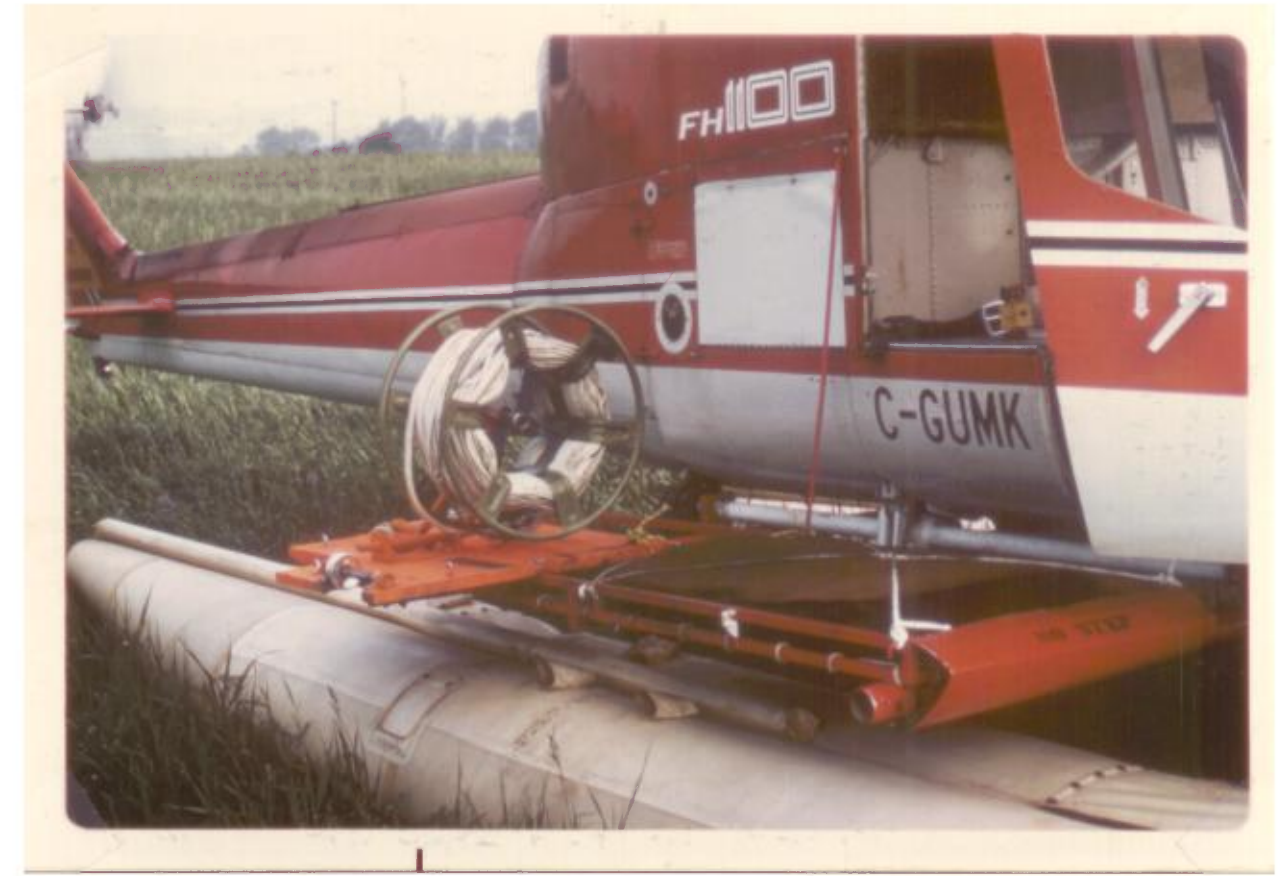
Figure 6- Côté droit de l'appareil FH-1100 montrant le moulinet à manivelle pour retirer la sonde de sédiments de fonds de lac solidement installée sur le support à cargaison.
