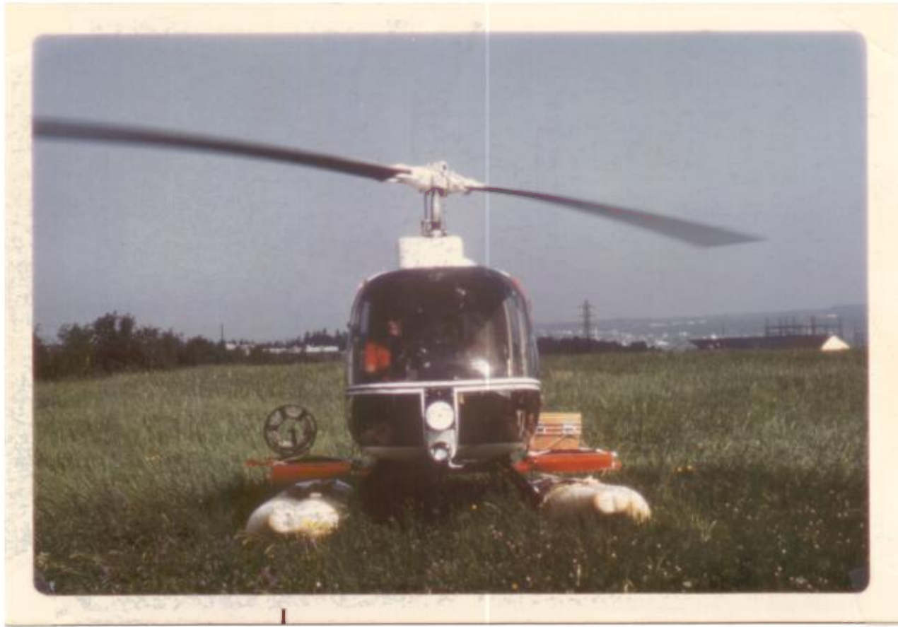
Figure 5- Vue de face de l'appareil Fair 1100 montrant clairement les supports à cargaison. GHC.
