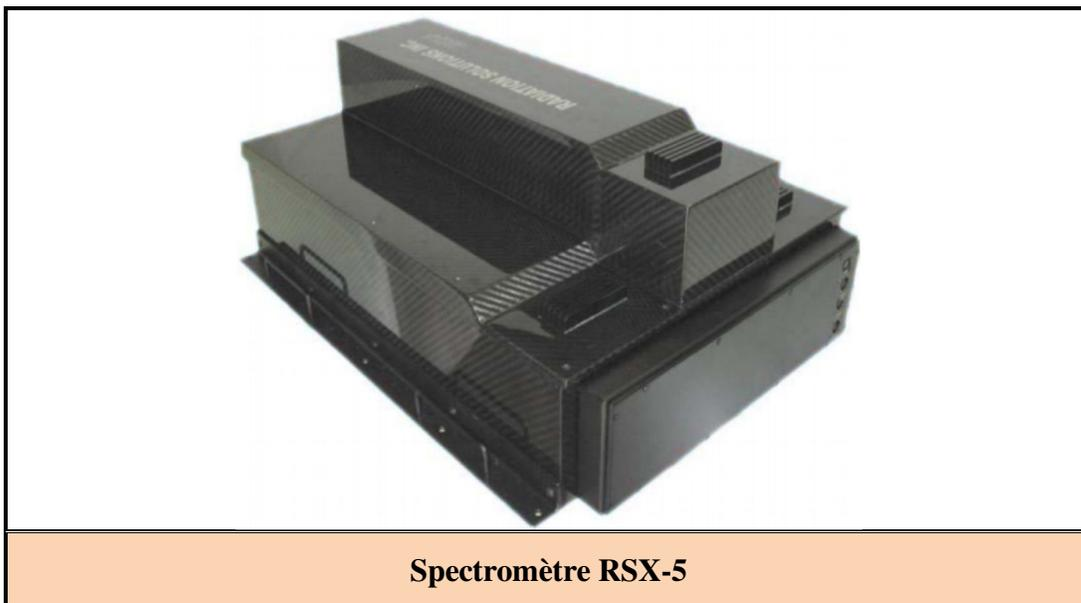
Les spectromètres ont enregistré le spectre de rayons gammas avec une résolution de 1024 canaux. Les cristaux de NaI sont thermiquement isolés afin de limiter les dérives et sont placés dans l'avion de telle sorte que le réservoir de carburant n'agisse pas comme écran à la détection des rayons gamma. L'enregistrement des données spectrales a été fait à chaque seconde.
