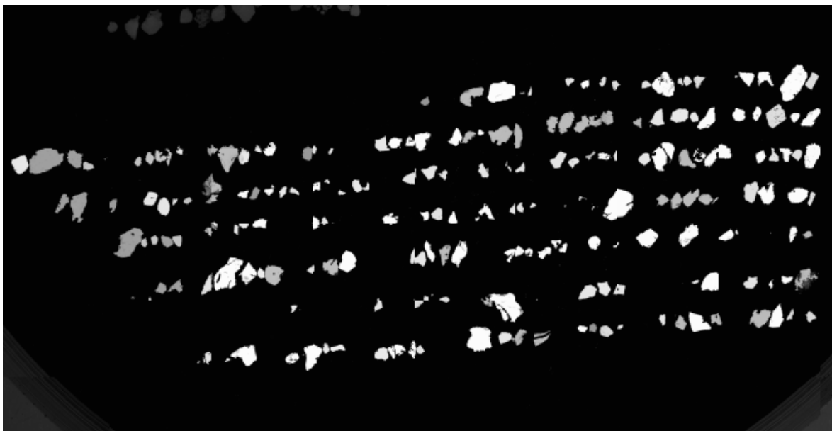
Photo 5 : Mosaïque de l'imagerie par rétrodiffusion des rangs de sulfures présents sur la pastille 1170-2. Chaque rang de grains représente un ou plusieurs échantillons. La largeur approximative de l'image est de 22 mm. Les différentes teintes de gris permettent de distinguer plusieurs types de sulfures.
