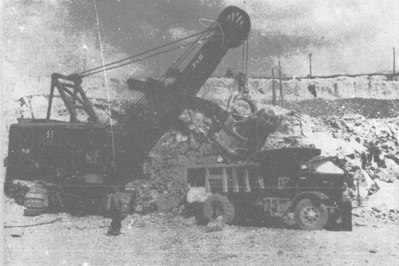
La mine Jeffrey, à Asbestos. Une pelle électrique charge la roche amiantifère dans un camion Diesel. Coutoioie de Canadian Johns-Manville Company Ltd.
